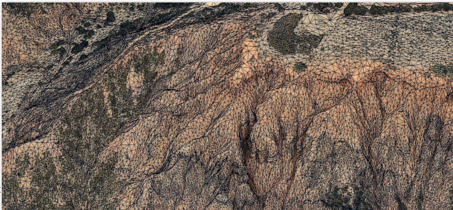
Tzw. reality mesh wygenerowany w oprogramowaniu ContextCapture na potrzeby monitoringu wybrzeża klifowego w Australii
