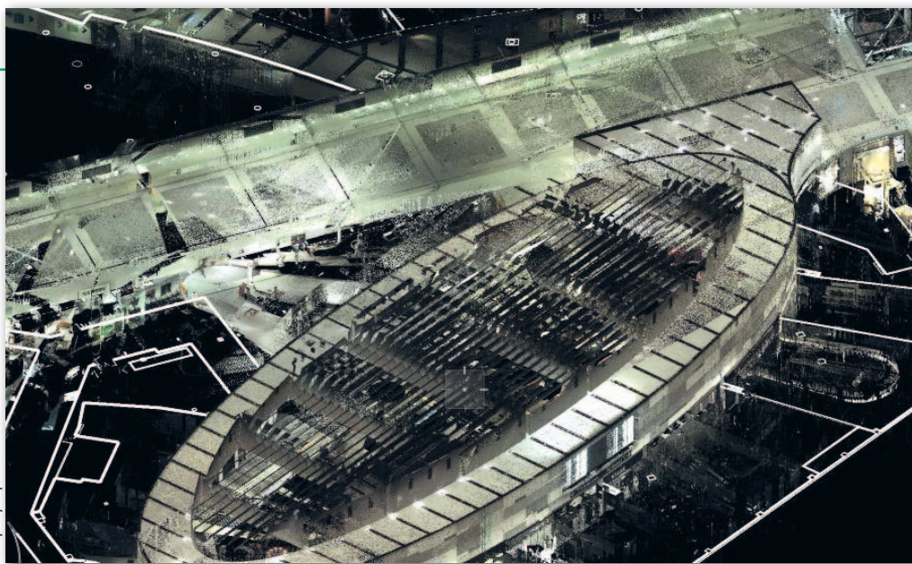
Efekt skanowania laserowego budynków portu lotniczego w Sydney
