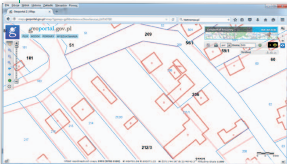
Rys. 6. Różnice między danymi katastralnymi z usług powiatowych (kolor niebieski) i danymi „o charakterze katastralnym” z Geoportalu (kolor czerwony)
