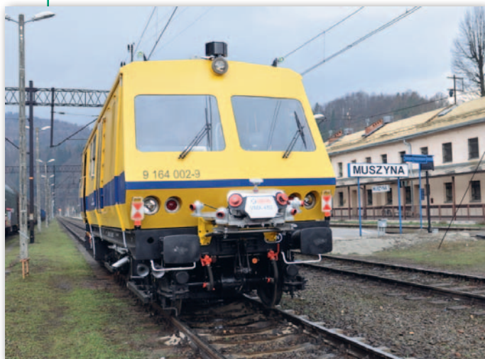
Rys. 1. Widok pojazdu EM-120 z zainstalowanymi urządzeniami pomiarowymi
