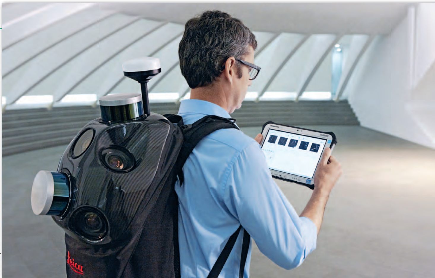
Leica Pegasus:Backpack – połączenie skanera laserowego, odbiornika GNSS oraz jednostki inercyjnej. W zamierzeniu producenta wynalazek jest przeznaczony przede wszystkim do cyklicznej inwentaryzacji budynków
