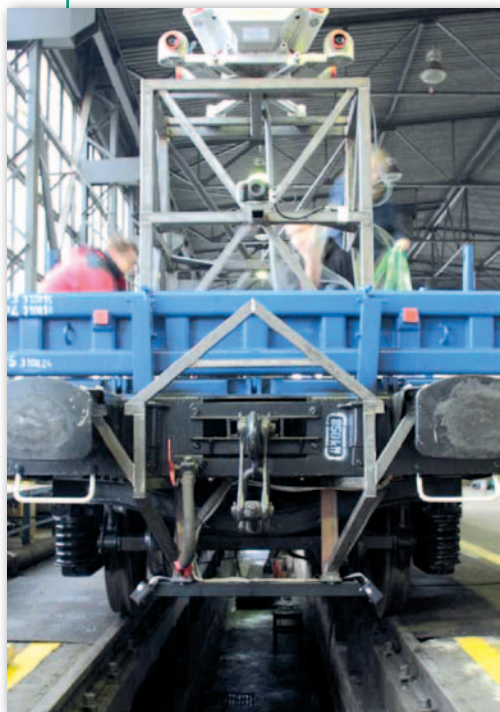
Rys. 3. System Riegl 450 w czasie montażu na platformie pomiarowej
