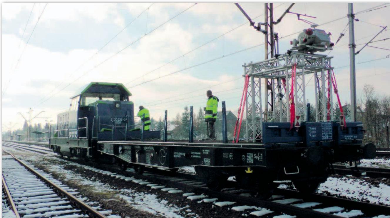
Rys. 4. System Riegl VMX 450 zamontowany na wagonie Smms 426Z
