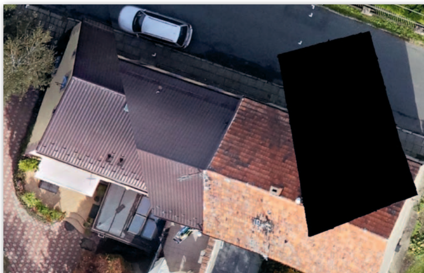
Rys. 4. Typowe błędy ortomozaiki wykonanej w sposób automatyczny z bloków zdjęć o małym pokryciu (60% na 60%)
