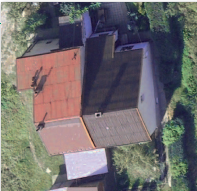
Rys. 2. Przykład sytuacji, kiedy ortoobraz (po lewej) pozwala na pomiar narożników niewidocznych na ortofotomapie (po prawej)
