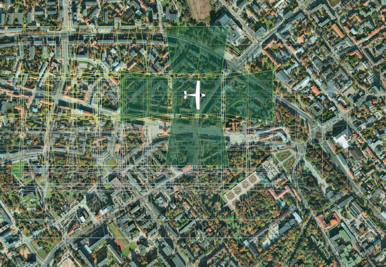
Schemat pozyskiwania zdjęć z pięciu niezależnych kamer i z wykorzystaniem skaningu laserowego
