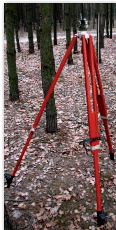
Rys. 2. Statyw po renowacji
