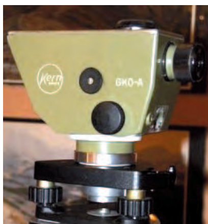
Rys. 8. Po lewej od góry trzy opisane niwelatory w towarzystwie współczesnego niwelatora Topcon (żółty). Drugi od lewej Kern GKO wyróżnia się miniaturowymi wymiarami. Zdjęcie po prawej – wykorzystanie reduktora do łączenia niwelatorów Kern z typowym gniazdem statywowym. Po lewej u dołu historyczny gadżet – tuba, w której wysłano mi plakaty Kern. Data nadania przesyłki to 5 września 1979. Sekretarka poczyniła błąd w moim nazwisku, ale wybaczyłem jej ten despekt
