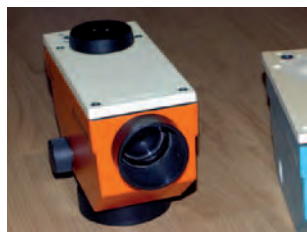
Rys. 9. Kolejne fazy upiększania niwelatora Kernlevel. Wnętrze fabrycznie nowej obudowy z napisem Leica zappełniły elementy dwóch innych egzemplarzy z nieco zmęczoną życiem obudową
