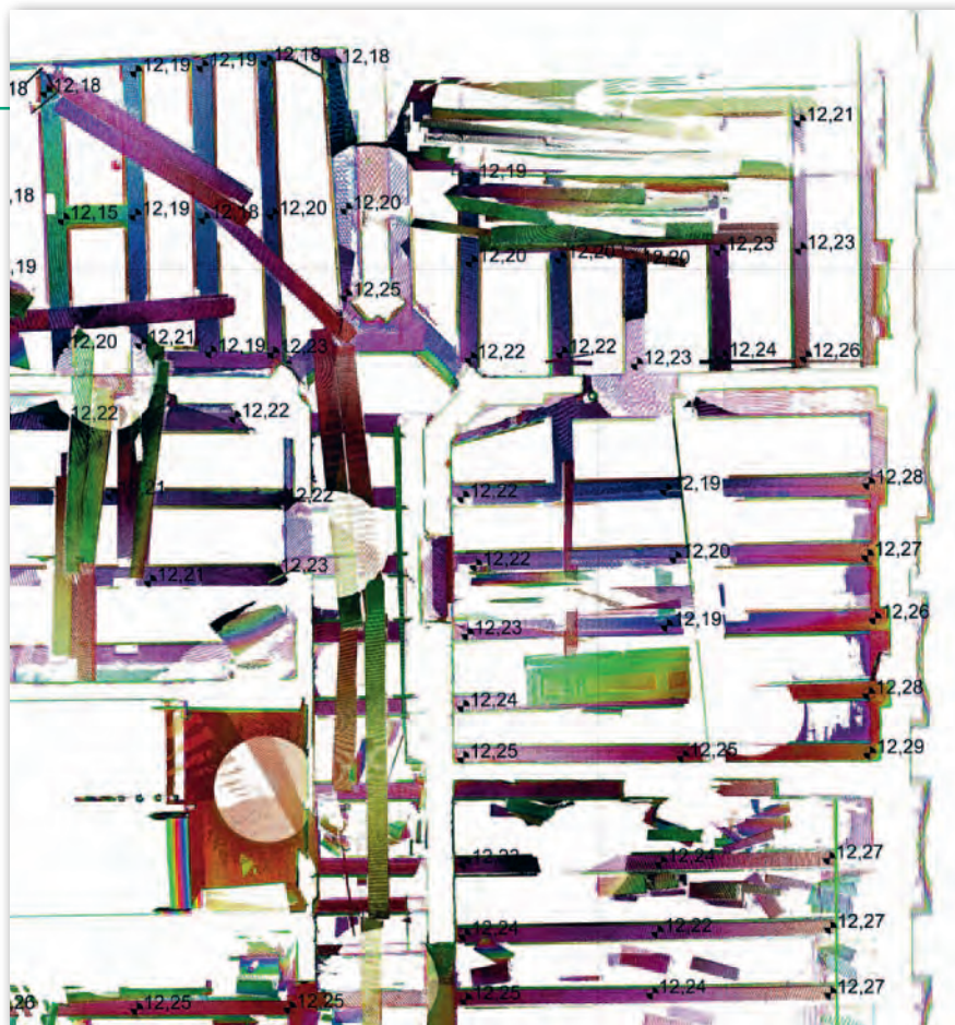
Inwentaryzacja belek oraz pomiar ich ugięć w jednej z poznańskich kamienic
