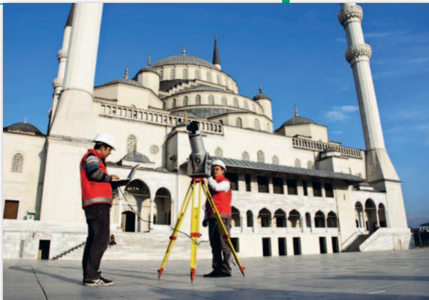
Skanowanie laserowe meczetu Kocatepe w Ankarze, zdjęcie wykonane podczas pomiarów realizowanych przez firmę Birlıklarita z Ankarą
