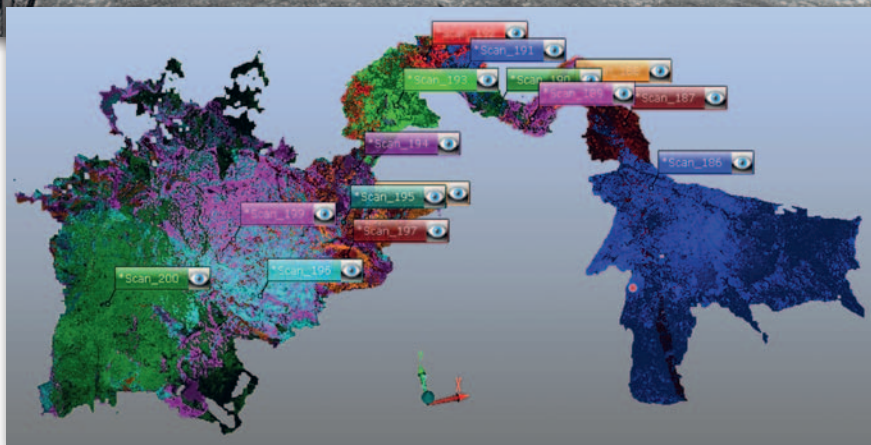
Fragment zeskanowanej jaskini. 15 pozycji skanera Trimble X5 3D. Od prawej: przejście z Sali Rycerskiej przez Kuchnię do Sypialni Jaskini Łokietka (OPN). Kolory oznaczają pojedyncze stanowiska skanera
