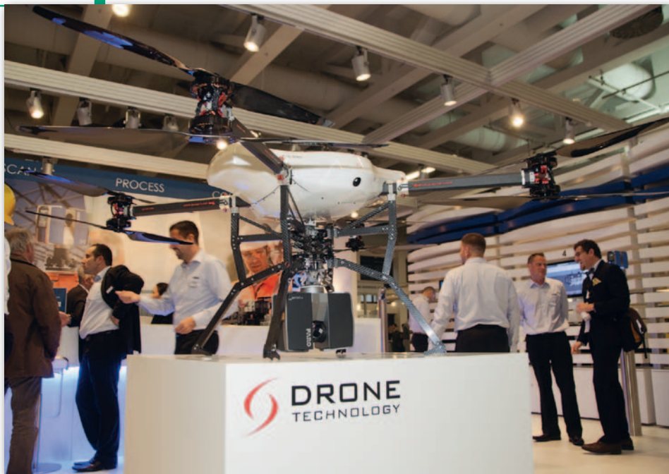
Ten dron ze skanerem Faro Focus 3D potrafi mierzyć nieprzerwanie nawet przez 40 minut
