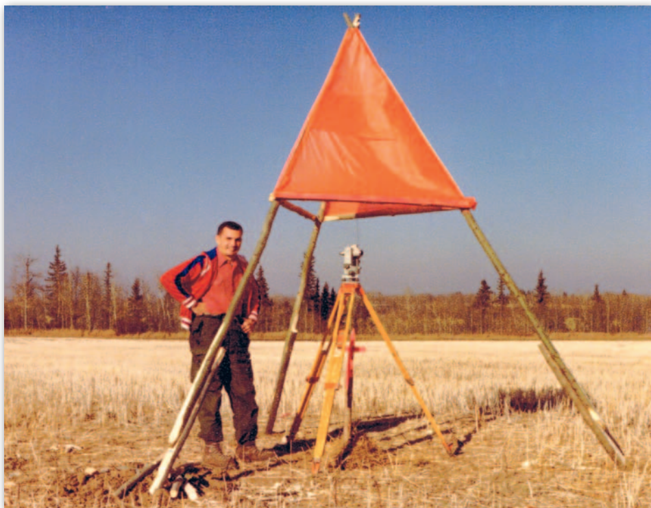
Pomiary punktów triangulacyjnych pod zaporą Dicksona. Punkty pierwszego rzędu były co 30 km, więc kontaktować się można było tylko przez tellurometr (dalmierz), który miał też zakres radiowy do komunikacji głosowej. Kąty nadal mierzono teodolitem, 1980 r.
