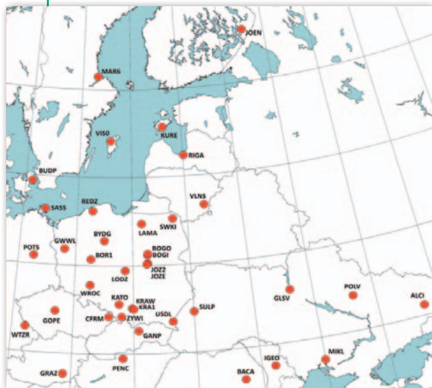
Rys. 1. Stacje nawiązania wykorzystane do opracowania sieci ASG-EUPOS w układzie ETRF2000(R08)
