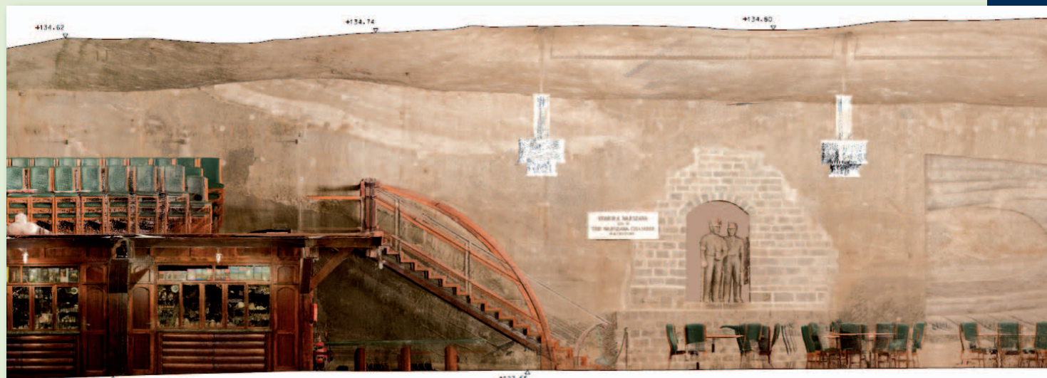
Ortofoto wygenerowane z chmury punktów wraz z linią przekrojącą narysowaną w MicroStation
