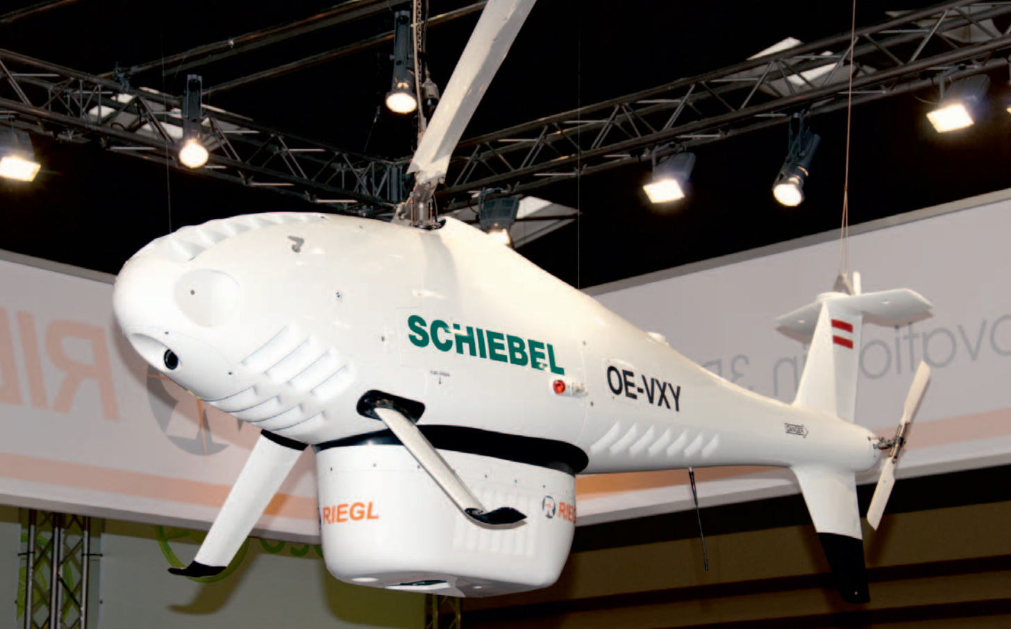
Bezpilotowy system do skanowania wybrzeża Camcopter S-100
