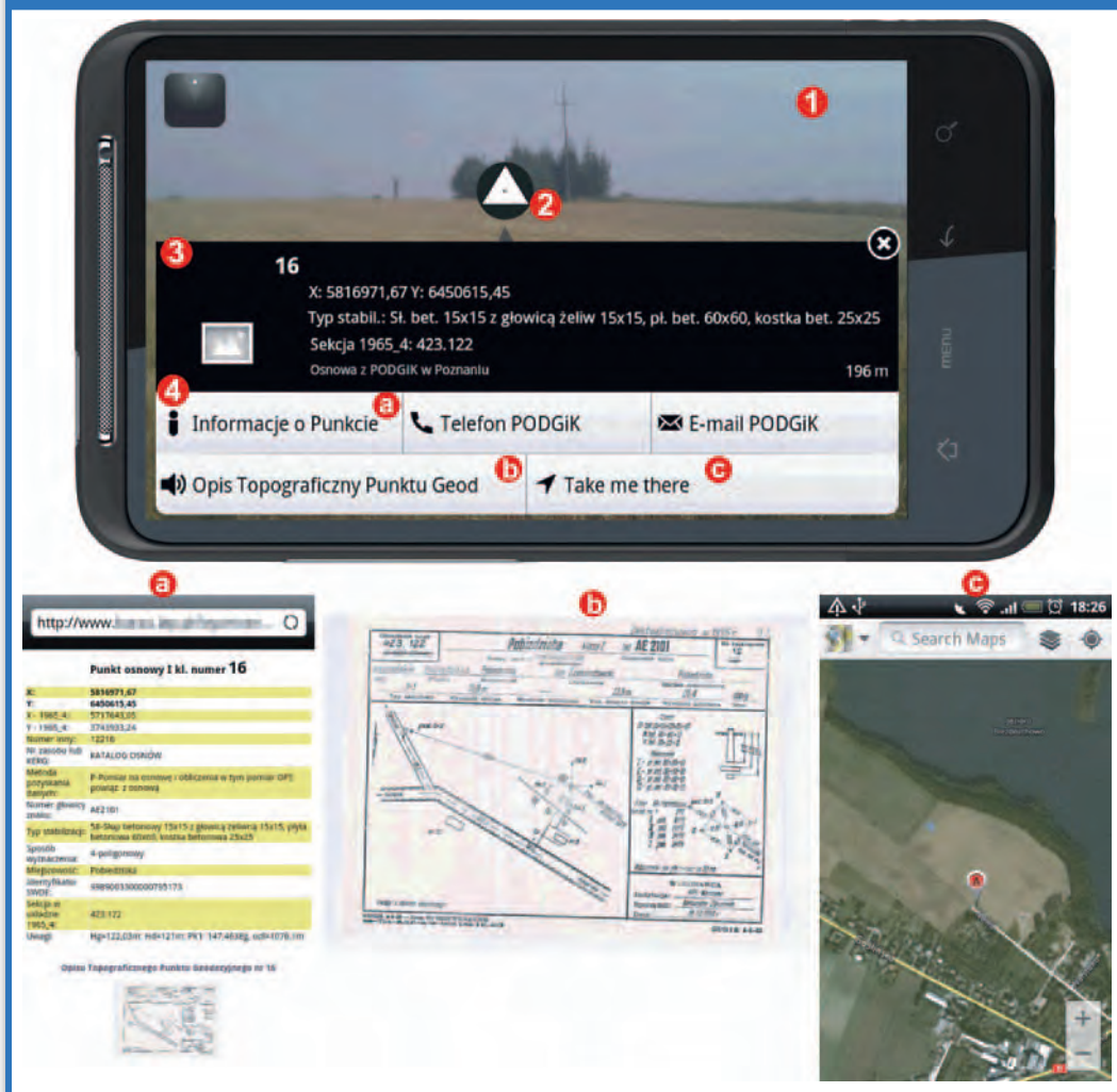
Rys. 4. Wizualizacja informacji o punkcie osnowy geodezyjnej w systemie rozszerzonej rzeczywistości
