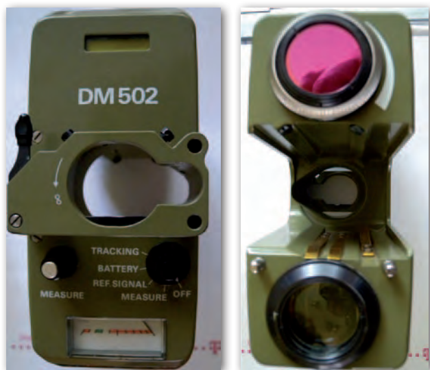
Moduł dalmierczy widziany od tyłu i od przodu (dolny obiektyw to nadajnik, górny z czerwonym filtrem – odbiornik)
