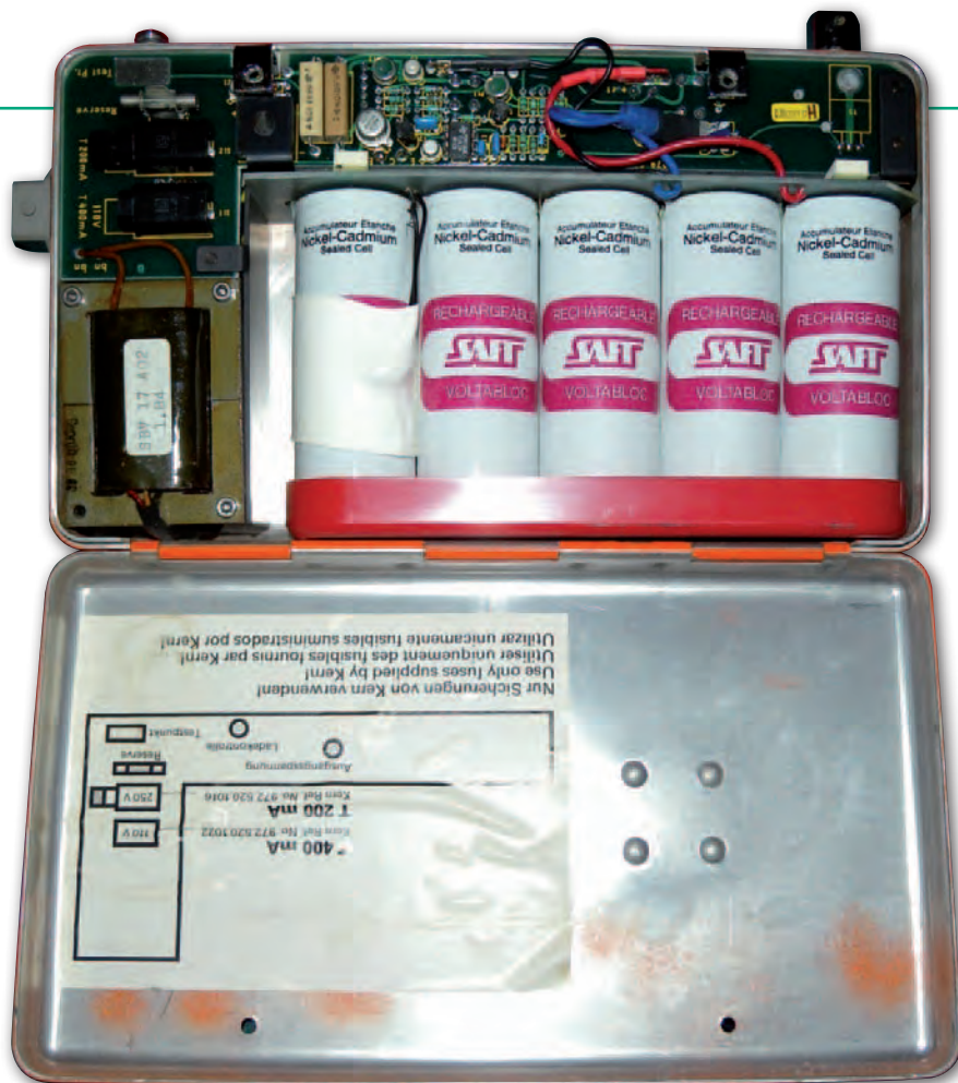
Wnętrze oryginalnego akumulatora
