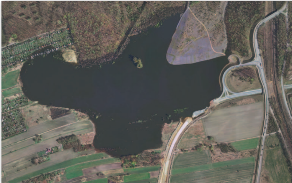
Wizualizacja powiększającego się najbardziej spektakularnego zbiornika bezodpływowego „Brandka”. Widoczna niedokończona obwodnica miasta - wstrzymana z powodu postępujących szkód górniczych. Lewy górny narożnik przedstawia presję zbiornika na ogródki działkowe
