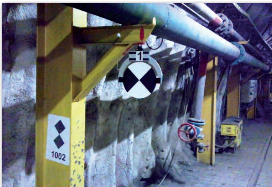
Rys. 3. Widok punktu wiążącego (nr 1002) oraz punktu kontrolnego (nr 1) wraz z firmową tarczą Z+F gwarantującą wysoką precyzję wyznaczenia jej centra
