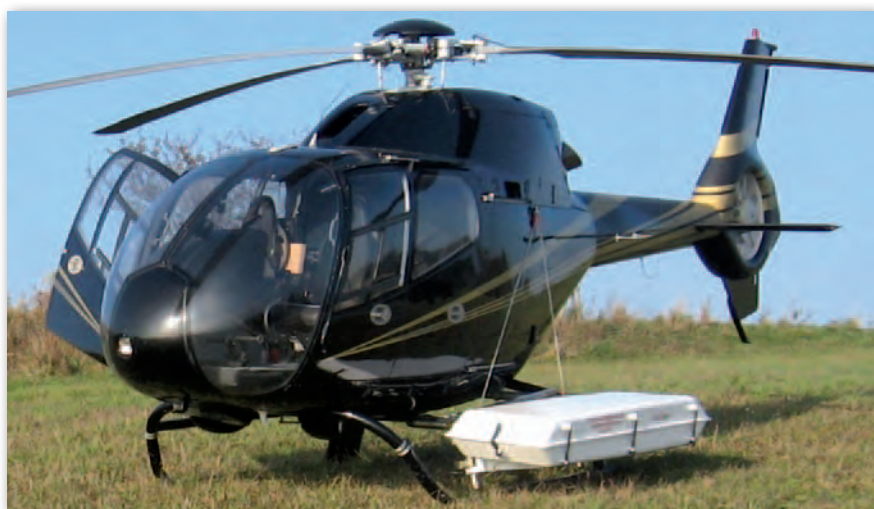
Śmigłowiec z łatwym do montażu i obsługi zasobnikiem ze skanerem i kamerami
