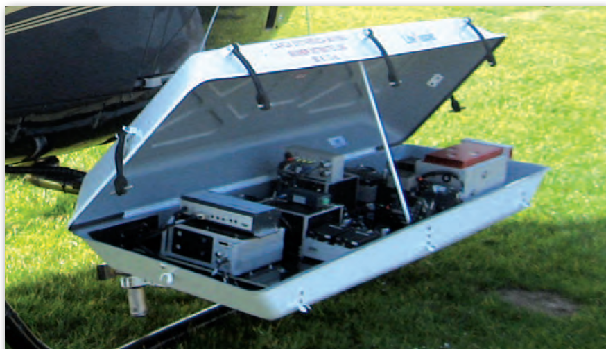
Śmigłowiec z łatwym do montażu i obsługi zasobnikiem ze skanerem i kamerami
