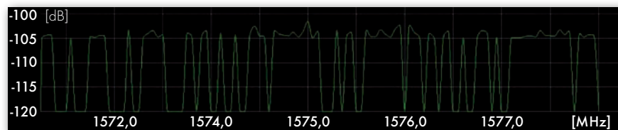
Rys. 10. Widmo sygnału L1 wraz z sygnałem zagłuszanym (moc dla danej częstotliwości)
