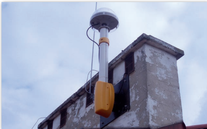
Przykładowe konstrukcje masztu anteny stacji referencyjnej
