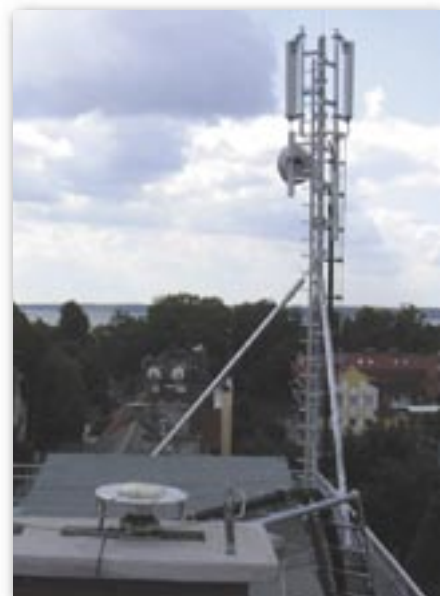
1. Wykonanie obserwacji w miejscu projektowanej lokalizacji anteny stacji referencyjnej w Giżycku, jednocześnie badanie zakłóceń sygnału GPS w pobliżu zestawu BTS systemu GSM
