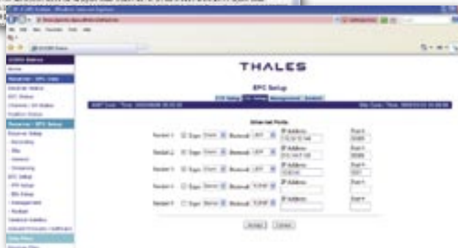
5. Korekty różnicowe DGPS/RTK wysyłane są jednocześnie do autorskiego systemu dystrybucji poprawek przez VPN, na lokalny komputer monitorujący stację referencyjną GPS oraz na zdalny komputer monitorujący
