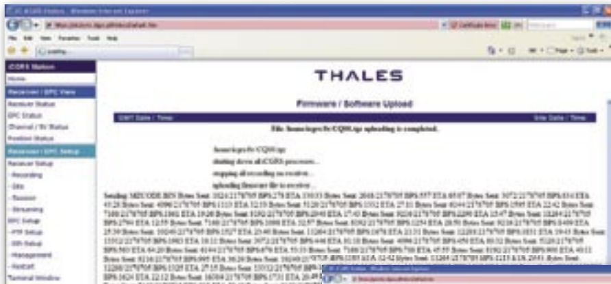
4. Proces zdalnej aktualizacji firmware odbiornika GPS przez stronę www generowaną w odbiorniku GPS
