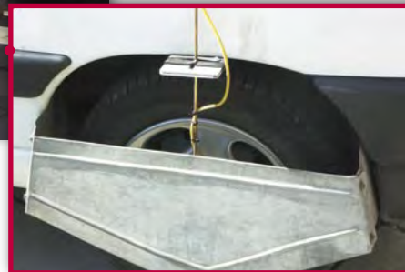
Odometr – urządzenie do pomiaru przejechanej odległości
