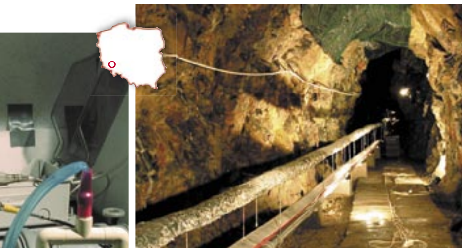
2. Korytarze obserwatorium w podziemiach zamku w Książu (wzdłuż ściany jedna z gałęzi klinometru hydrostatycznego) oraz stanowisko pomiarowe klinometru (miernik interferencyjny)
