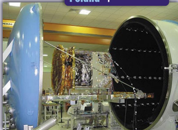
Moduł satelity Galileo GSTB-V2/B wprowadzany do komory próżniowej (laboratorium Alenia Spazio w Rzymie)
