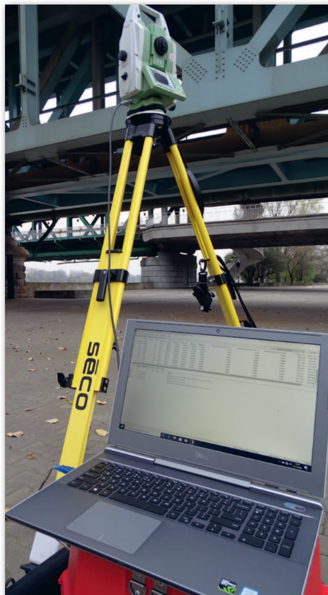
Testowany mobilny system do monitoringu przemieszczeń przed Kolejowym Mostem Gdańskim w Warszawie
