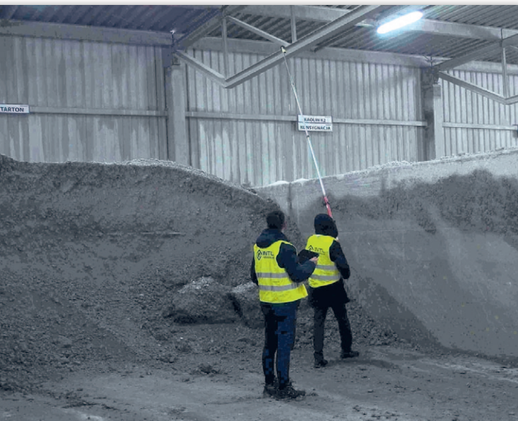
Rys. 4. Pomiar kamerą immersyjną na 5-metrowym wysięgniku
