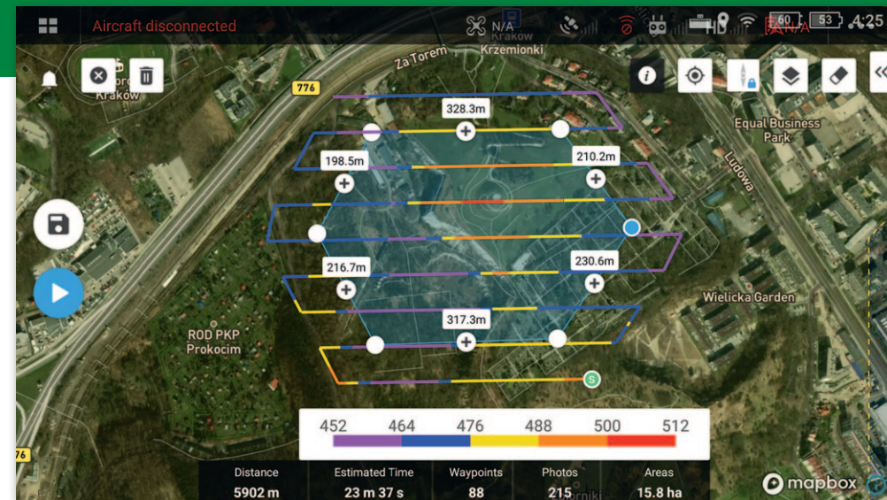
Rys. 2. Zaplanowany nalot w DJI Pilot z uwzględnieniem deniwelacji terenu
