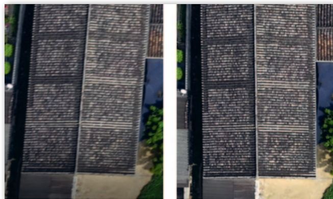
Rys. 1. Zdjęcie wykonane kamerą z migawką szczelinową z widocznym efektem rolling-shutter (po lewej) i wykonane kamerą z migawką global-shutter (po prawej)
