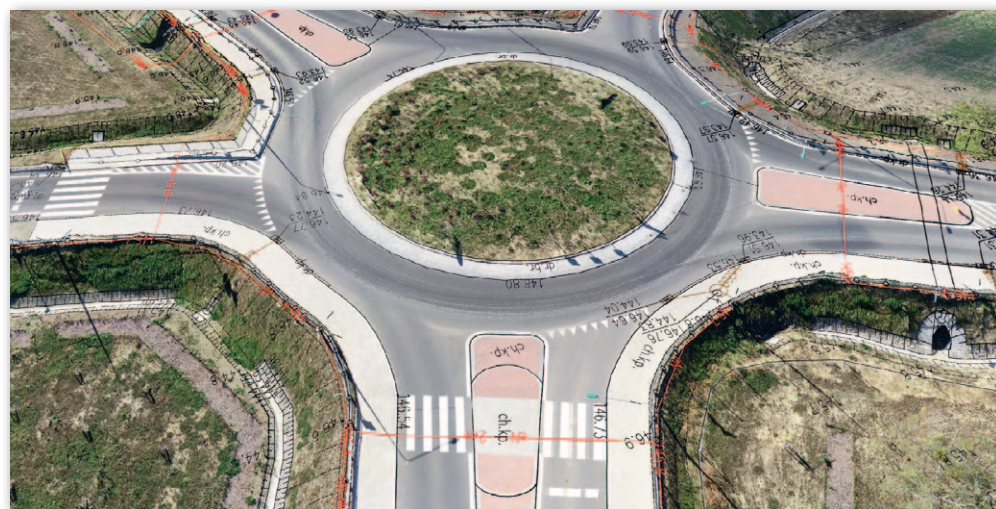
Model 3D wygenerowany na podstawie danych z drona WingtraOne z nałożonymi warstwami wektorowymi – droga S7 (węzeł Rychnowo)
