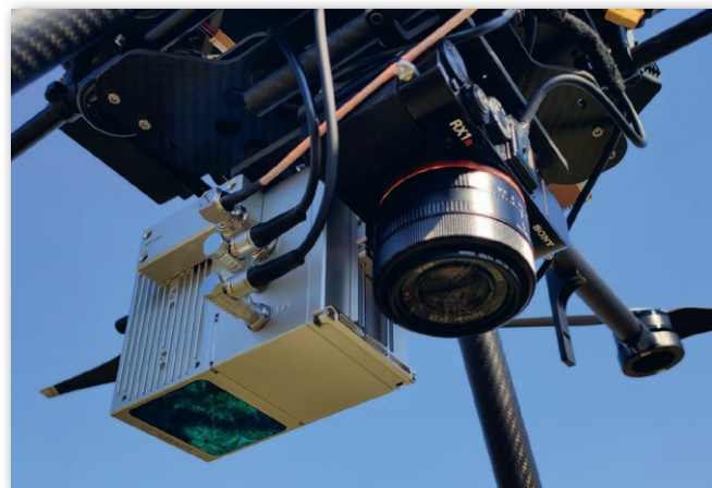
6. System ULS GS-260P (Geosun) z kamerą Sony RX1RII zamontowany na wirnikowcu DJI M600Pro
