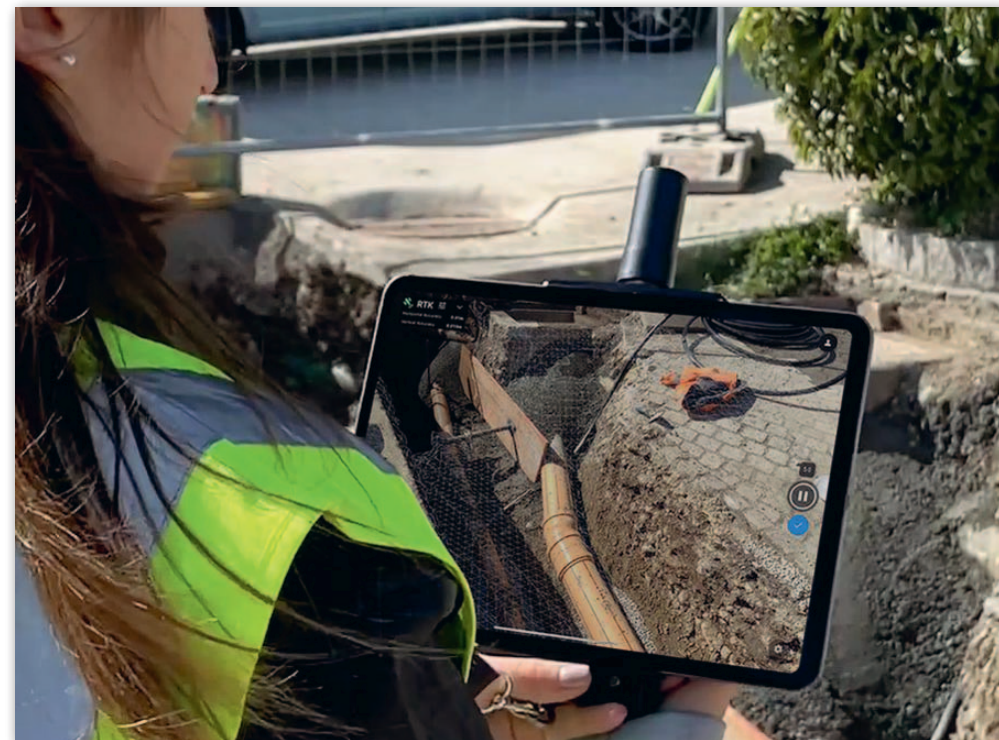
System viDoc RTK pozwala wykorzystać iPhone’a lub iPada do generowania modeli 3D o centymetrowej dokładności
