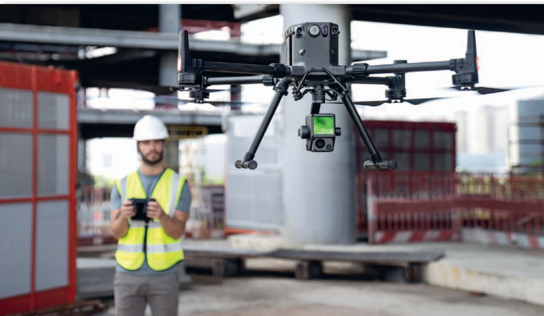
Wirnikowiec DJI Matrice 300 z podwieszonym skanerem Zenmuse L1
