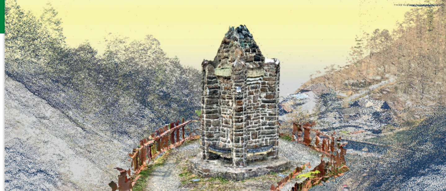
Integracja chmur punktów z lotniczego skanowania laserowego oraz chmury wyeksportowanej z aplikacji beta Capture z tabletu iPad Pro (zobacz także: youtu.be/dpl44Pv0Xdw )
