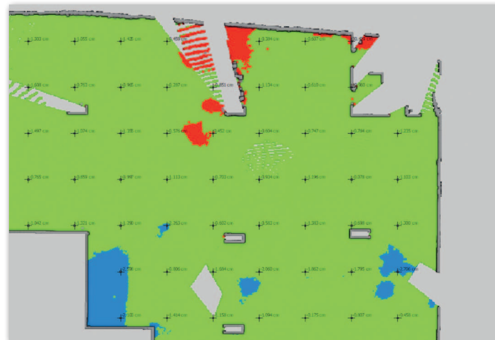
4. Kolorystyczna mapa odchyłek poziomości wraz z siatką punktów z dokładnymi wartościami (oprogramowanie Gexcel Reconstructor)
