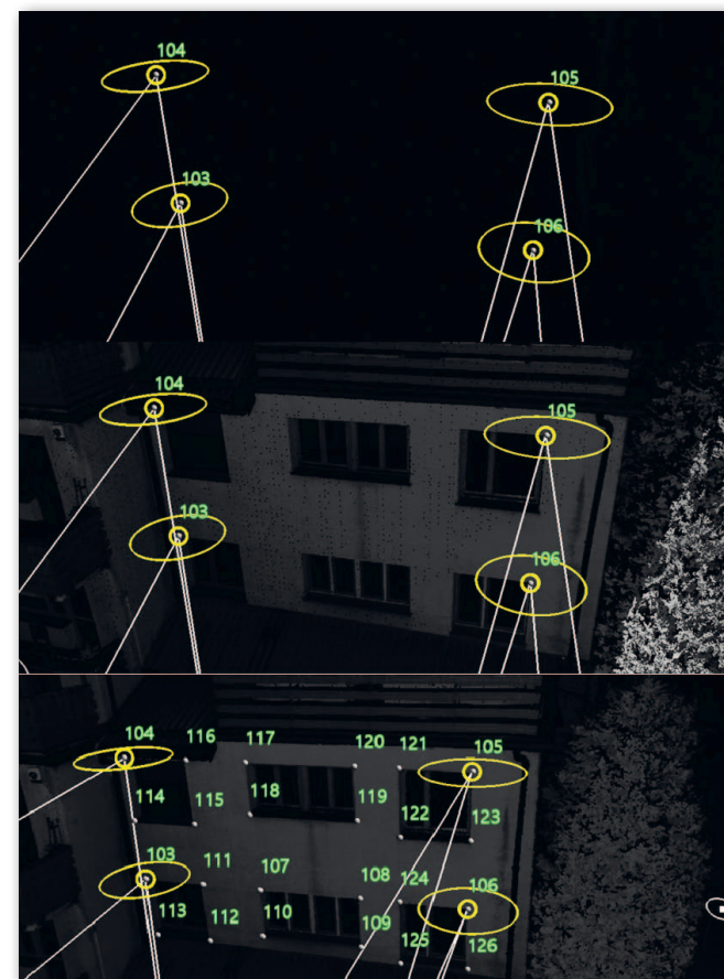
8. Od góry: punkty zmierzone tachymetrycznie, punkty zmierzone tachymetrycznie wraz z chmurą punktów, uzupełnienie danych z pomiaru tachymetrycznego punktami pozyskanymi ze skanu 3D
