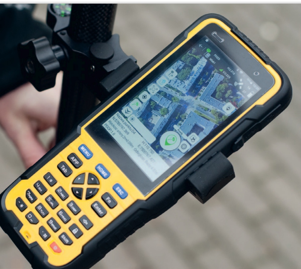
Pomiar z włączonym IMU w aplikacji Kolidy SurvX 4
