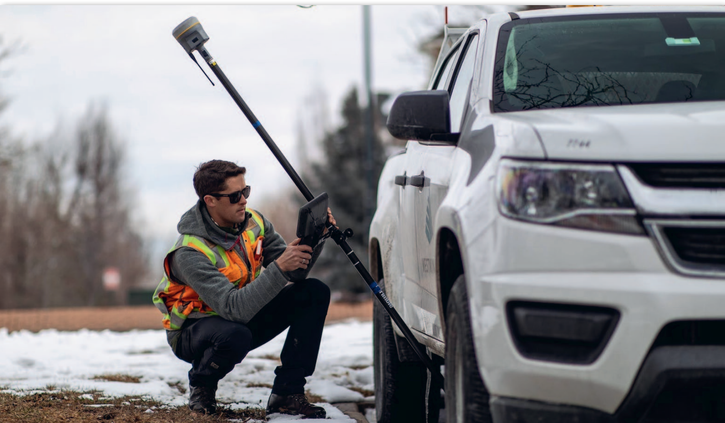
Trimble R12i – pierwszy odbiornik tego producenta wyposażony w pochylomierz z IMU
