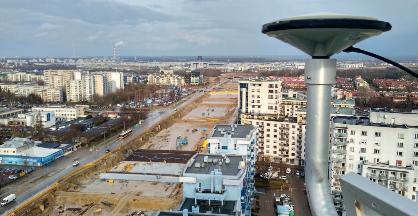
Element systemu SmartSense do monitoringu ciągłego zamontowany na budynku przy skrzyżowaniu alei KEN i ulicy F. Płaskowickiej
