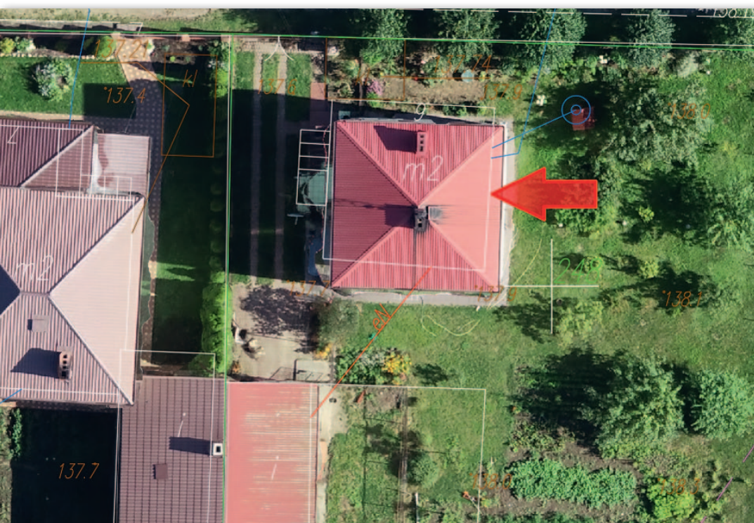
Rozbieżność usytuowania budynku wykryta na podstawie porównania ortofotomozajki i wektorowej mapy do celów projektowych
