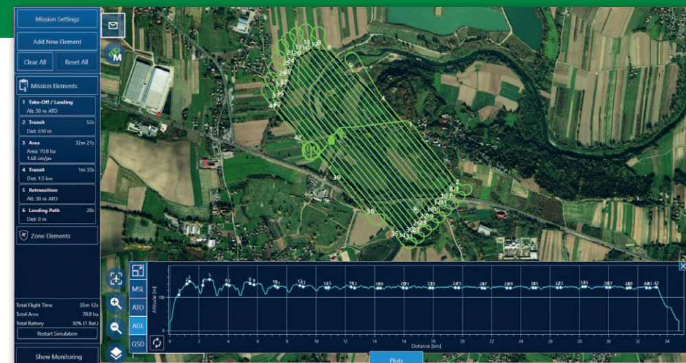
Zaplanowana misja fotogrametryczna w oprogramowaniu QBase3D
