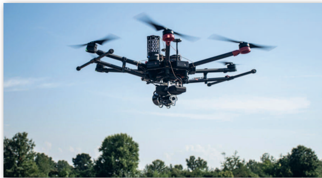
Dron wyposażony w system TruView łączący 2 kamery i lidar
