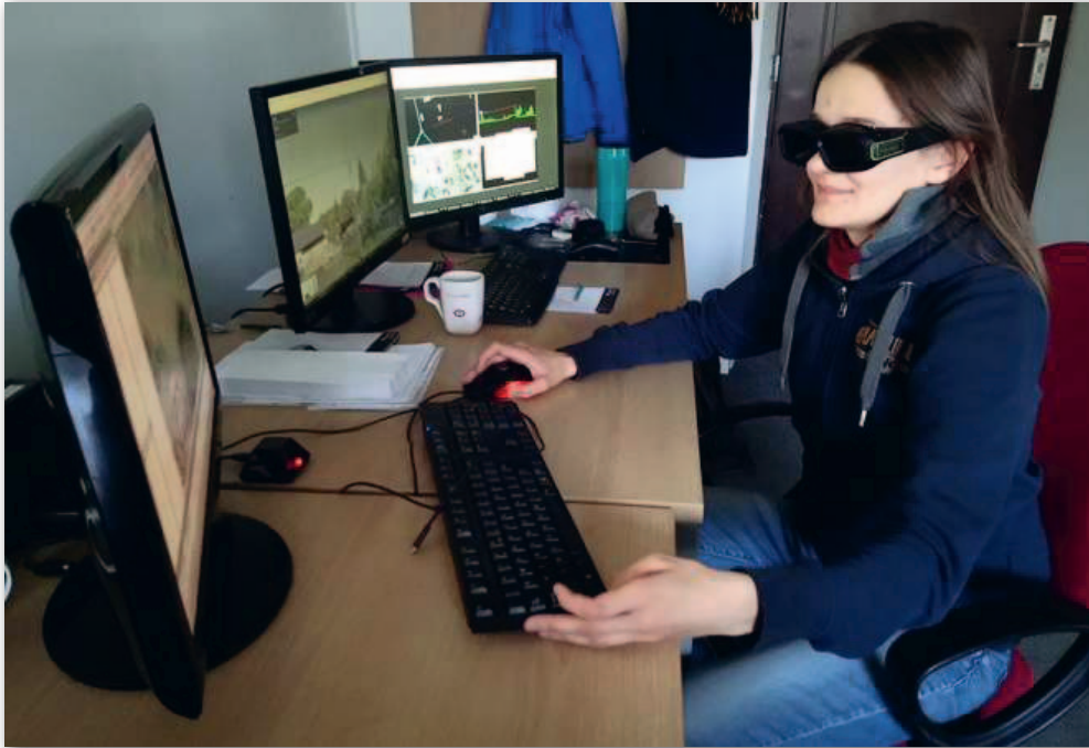
Pomiar stereoskopowy linii strukturalnych na stacji fotogrametrycznej
