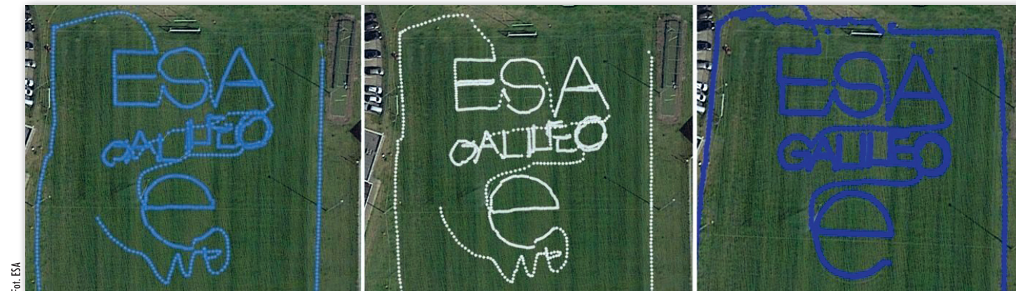
Porównanie pomiarów Galileo (od lewej): jednoczęstotliwościowych (na kanale E1), dwuczęstotliwościowych (E1 i E5) oraz dwuczęstotliwościowych wspieranych korektami PPP
