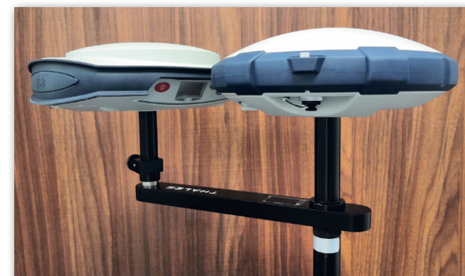
Odbiorniki SP60 i SP85 (z lewej) na jednej tyczce przygotowane do pomiaru testowego
