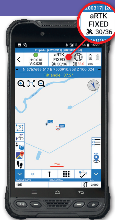
Nowy S900A po rozłączeniu z internetem utrzymuje rozwiązanie aRTK fixed z wykorzystaniem korekty satelitarnej do 20 min. Przykładowy pomiar aRTK fixed: 30 z 36 satelitów – dokładność H z 16 mm, V 26mm, wychylenie tyczki ponad 37°
