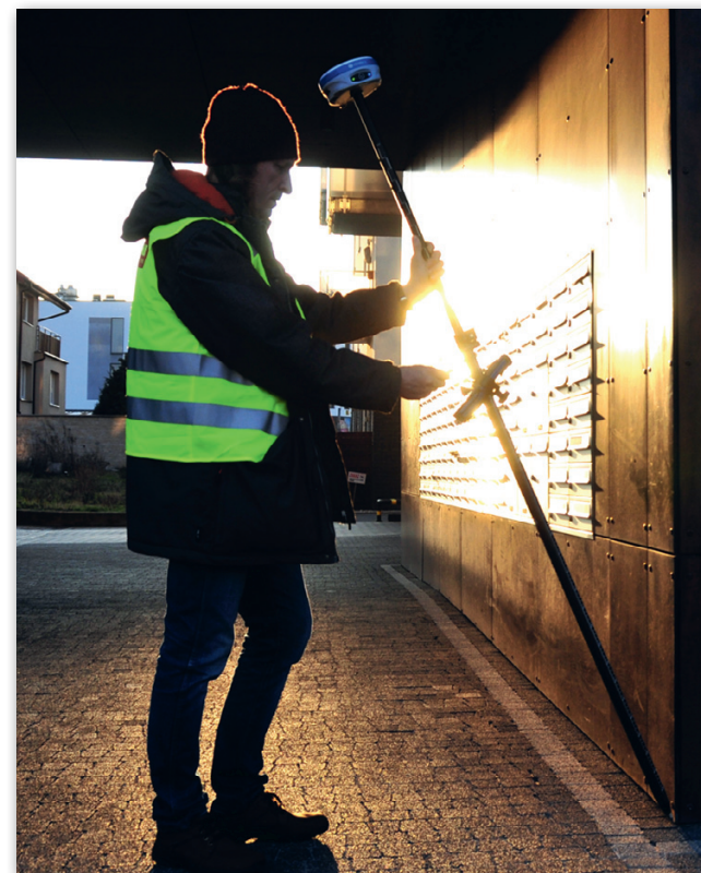
Pomiar z aktywnym IMU oraz nowym procesorem GNSS pozwala wyznaczyć nie tylko bezpośrednio narożnik, ale też radzić sobie z okapami, balkonami i innymi utrudnieniami
