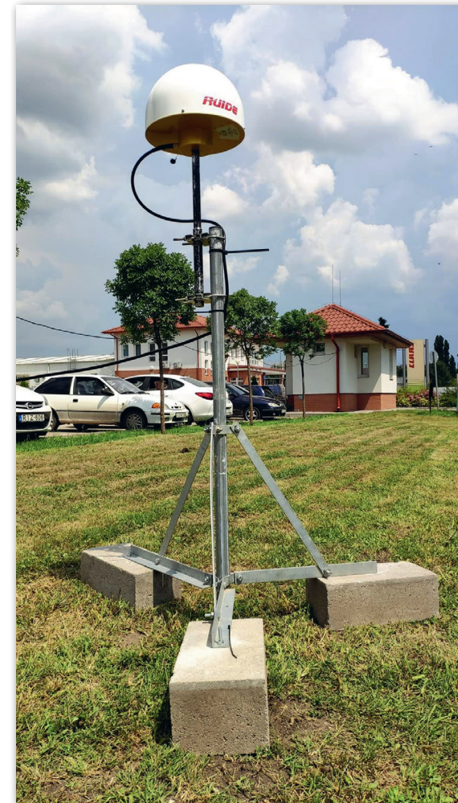
Stacja RtkNet w trakcie testów przed montażem
