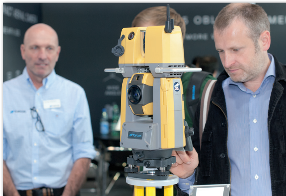
Topcon GTL-1000 jest połączeniem tachimetru i skanera laserowego. W ocenie producenta to świetne rozwiązanie do szybkiej i szczegółowej weryfikacji prac budowlanych
