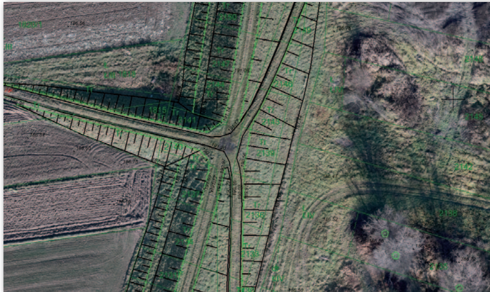
Fragment mapy do celów projektowych na podkładzie z ortofotomapy uzyskanej ze zdjęć z BSL
