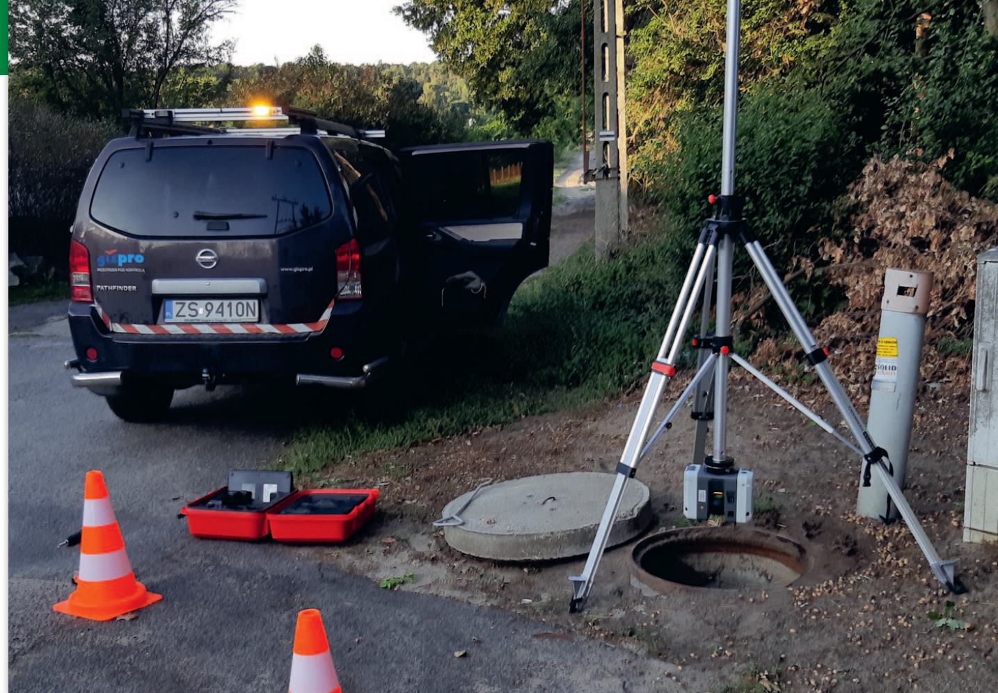
Rys. 2. Przygotowanie do wykonania pomiaru – zabezpieczenie terenu prac
