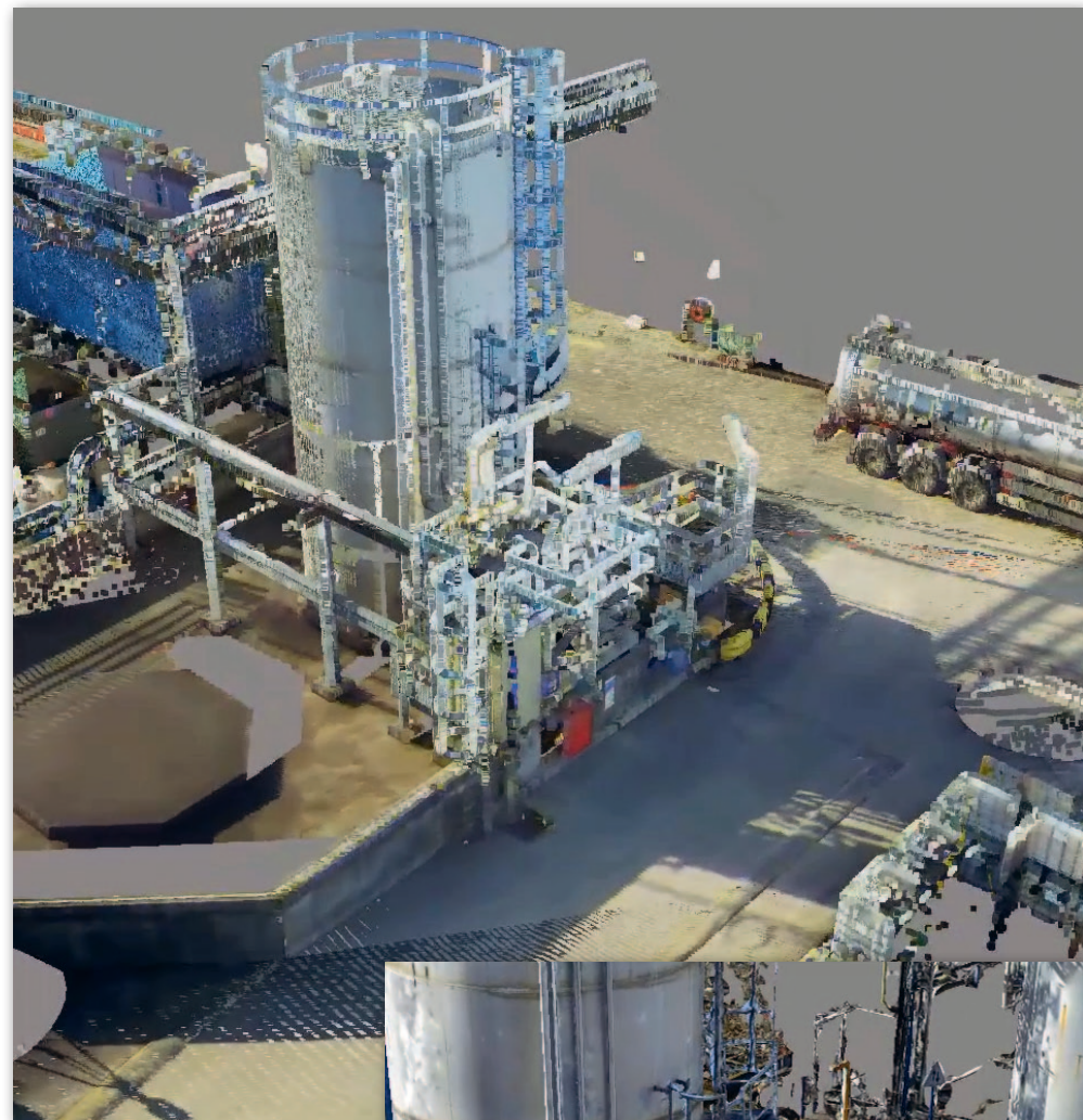
Porównanie chmury punktów (powyżej) z siatką rzeczywistości utworzoną z chmury punktów i zdjęć w Bentley ContextCapture (po prawej)
