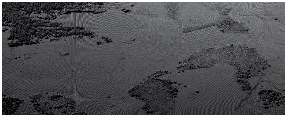
Ryc. 3.1. Obraz intensywności chmury punktów służącej do budowy modeli terenu na podstawie skaningu laserowego
