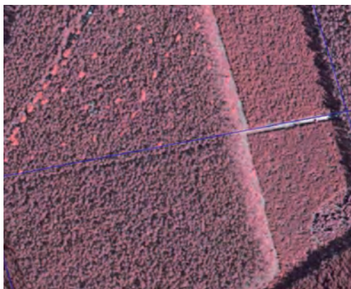
Ryc. 4.21. Przykład różnicy określenia przebiegu elementu liniowego na ortofotomapie. Ortofotomapa pokazuje prawidłowy przebieg linii oddziałowej w młodniku (linia przebiega na poziomie gruntu), a w drzewostanie dojrzałym obraz linii oddziałowej na ortofotomapie jest przesunięty (linia jest widoczna na poziomie koron drzew, a nie gruntu) (źródło: Miścicki 2007)
