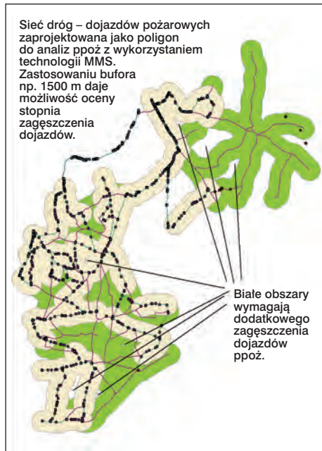
Ryc. 4.47. Przykłady trzech sieci: a – wielofunkcyjna, b – analiza błędów, c – dojazdy pożarowe) zbudowanych na podstawie danych z MMS
