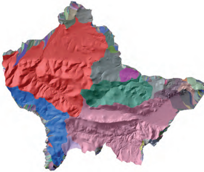
Ryc. 4.36. Model zlewni rzek dla LKP Sudety Zachodnie. Niewielkie obszary, które wyodrębniono jako zlewnie, są efektem obciążenia modelu NMT do określonego zasięgu. Aby uatrakcyjnić wizualizację, prezentowaną warstwę wynikową naniesiono na cieniowaną mapę obszaru.
