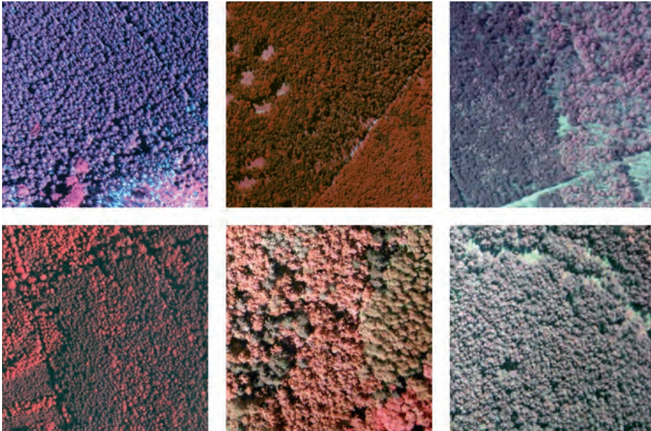
Ryc. 4.9. Przykłady różnic kolorystyki obszarów leśnych widocznych na zdjęciach spektrostrefowych wykonanych w różnych projektach
