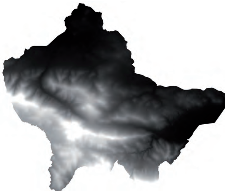
Ryc. 4.30. Wizualizacja numerycznego modelu terenu pozbawionego warstwy cienia – wysokość pokazana jest jedynie różnymi tonami szarości
