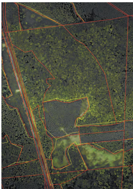
Ryc. 4.15. Zweryfikowany przebieg granic wyłączeń drzewostanowych na podstawie analizy fragmentu ortofotomapy lotniczej – kolorem czerwonym oznaczono prawidłowy przebieg granic, kolorem żółtym – przebieg wybranych linii przed weryfikacją
