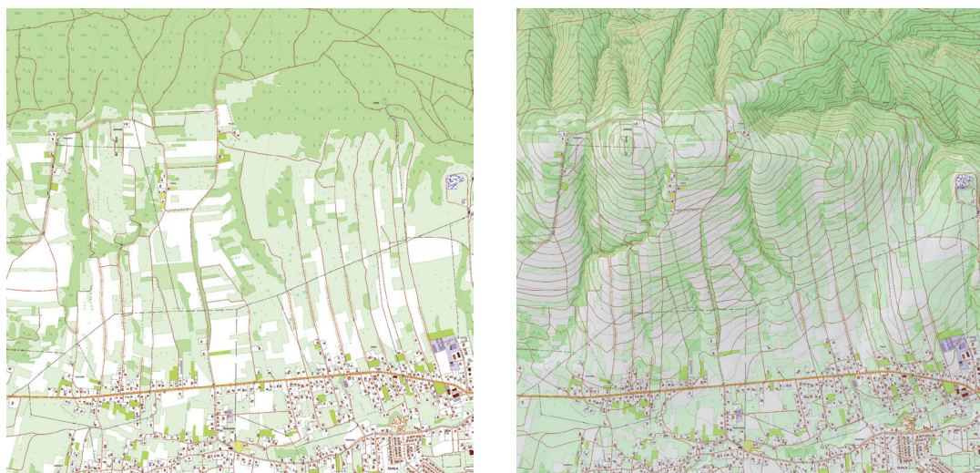
Ryc. 3.20. Fragment mapy topograficznej 1:10 000 generowanej z bazy BDOT10k: bez rzeźby terenu (z lewej) oraz z rysunkiem poziomocowym i cieniowaniem (z prawej)
