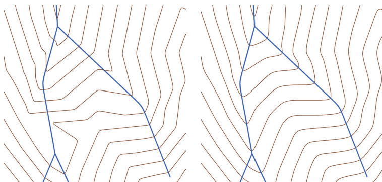
Ryc. 3.19. Poziomice opracowane na podstawie NMT: bez uwzględnienia cieków (z lewej) i z uwzględnieniem cieków (z prawej)
