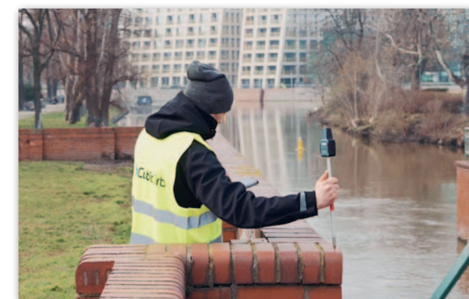
Pomiar ściany oporowej z wykorzystaniem L2 na minityczce
