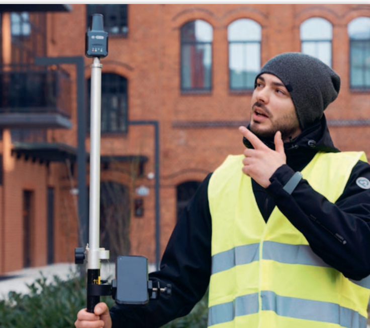
Odbiornik GNSS L2 z IMU. Na fot. z prawej pomiar i tyczenie narożnika budynku przy wychyleniach tyczki 30, 60, 90 i 110 stopni
