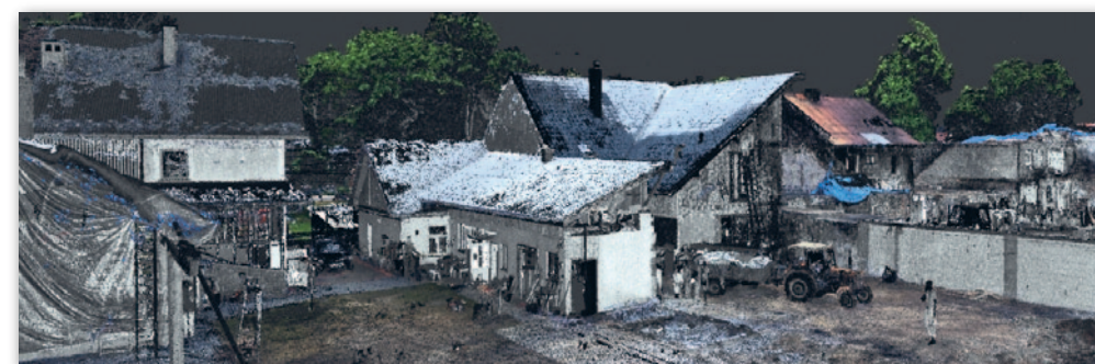
Jeden z finalnych produktów: zintegrowana chmura punktów TLS + UAV
