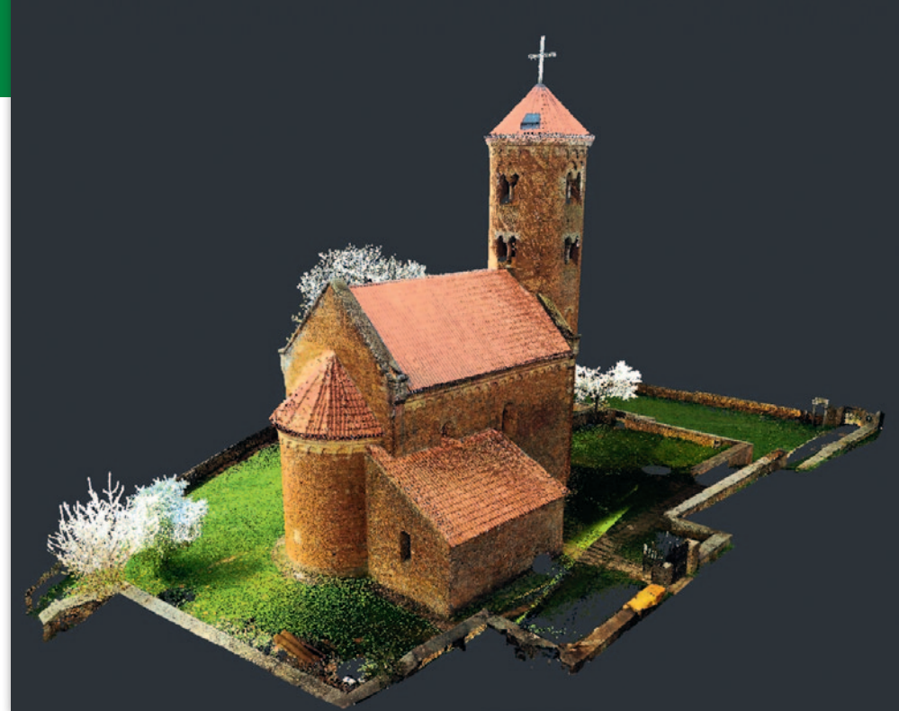
Połączona chmura punktów uzyskana ze skanów i zdjęć
