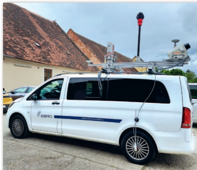
Rys. 2. System mobilnego mapowania zbudowany z dwóch skanerów laserowych i kamery 360 stopni
