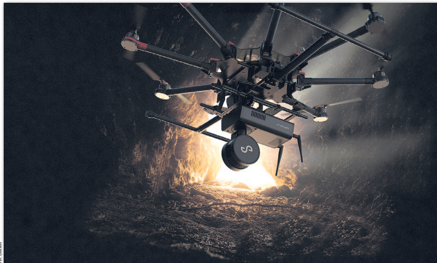
Skaner Hovermap ST firmy Emesent można zamontować nie tylko na dronie, ale również na aucie czy plecaku
