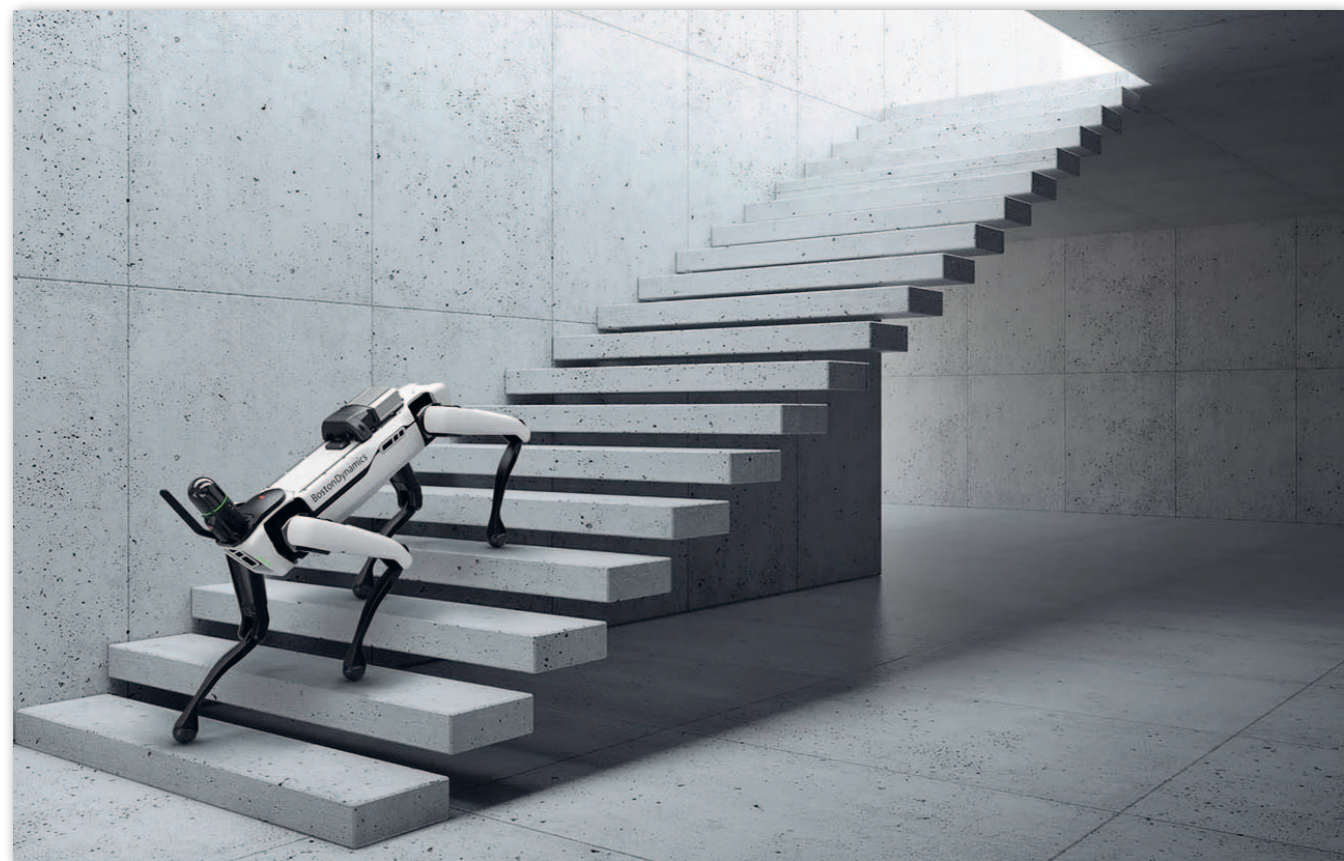
Robota Leica BLK ARC zaprojektowano z myślą o powtarzalnych pomiarach oraz skanowaniu miejsc niebezpiecznych lub niedostępnych dla człowieka. Podobne rozwiązania oferują również firmy Trimble i Faro
