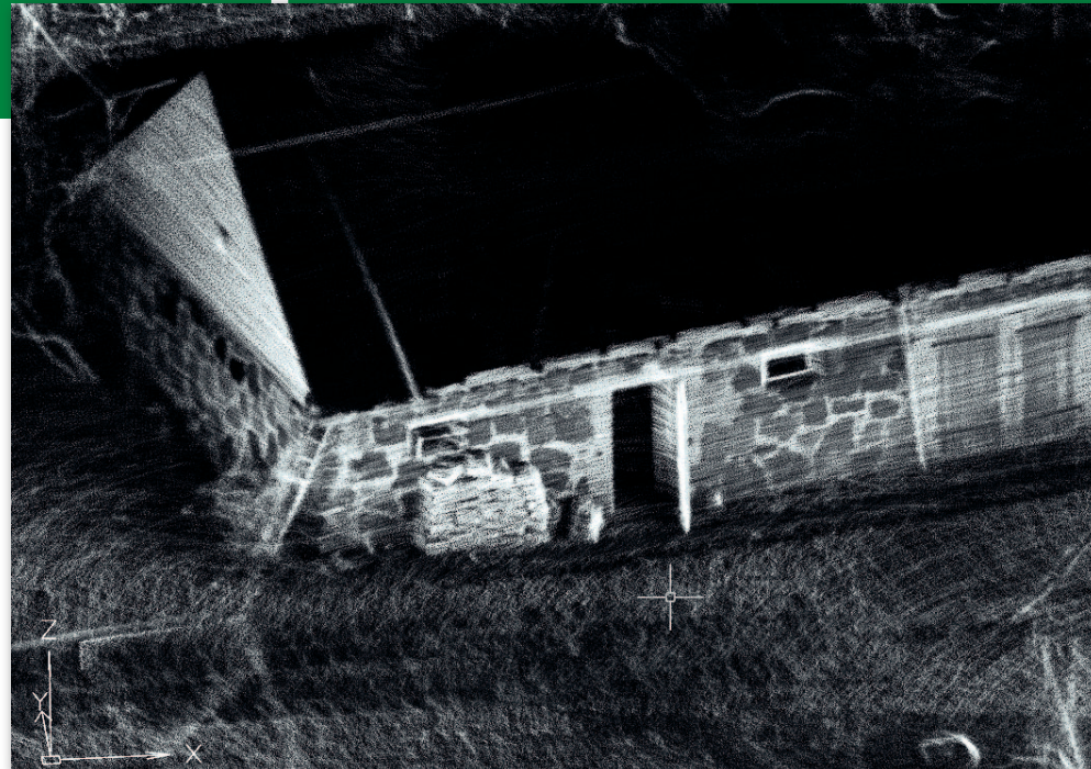
Plecak pomiarowy pozwala sprawnie pozyskać bardzo szczegółowe informacje o budynkach
