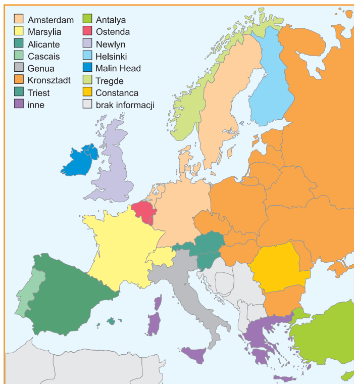
Rys. 2. Mareografy definiujące poziom powierzchni odniesienia krajowych wysokościowych układów w Europie (np. Kronszttadt, Amsterdam)
