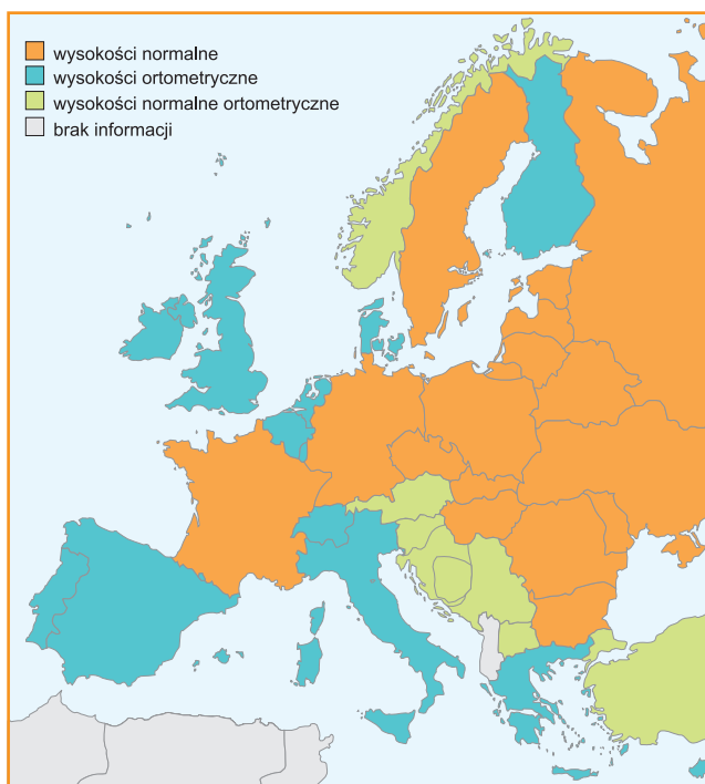
Rys. 3. Typy wysokości stosowane w krajach europejskich
