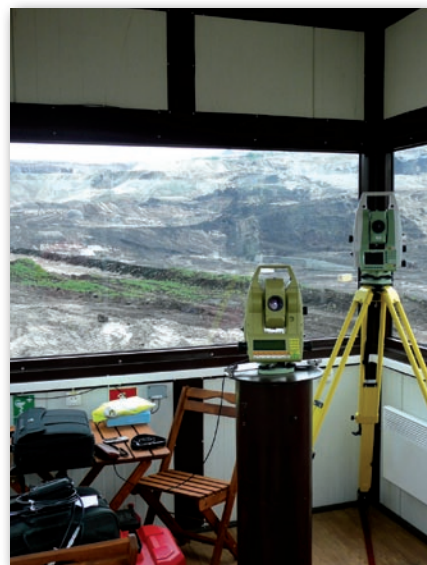
Stanowiska tachimetryczne wewnątrz kontenera pomiarowego systemu ciągłego monitoringu deformacji wyrobisk górniczych w odkrywce KWB „Bełchatów”
