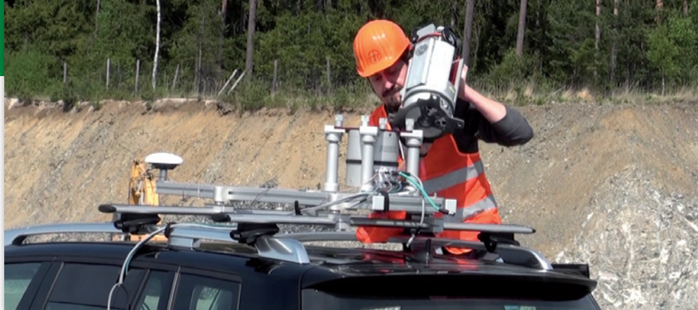
Dzięki kilku prostym ruchom skaner może być zamontowany na pojeździe i gotowy do mobilnego użycia
