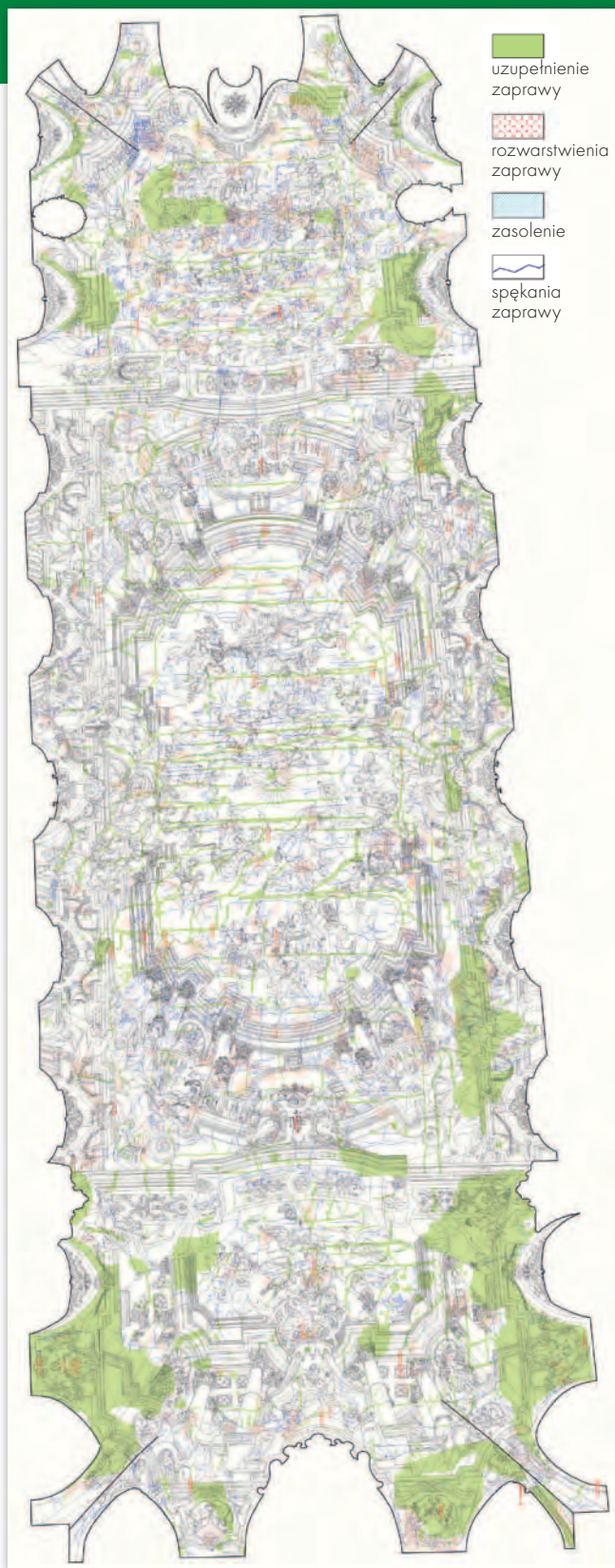
Sklepienie Auli Leopoldina. Z lewej ortofotoplan. Z prawej rejestr stanu zachowania wyprawy wapiennej wraz z warstwą malarską
