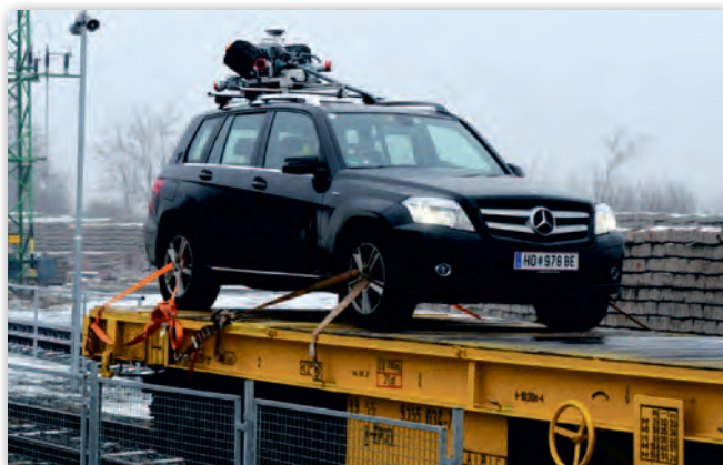
Wszystko gotowe do misji: Samochód z mobilnym systemem skanowania laserowego przymocowany do platformy kolejowej
