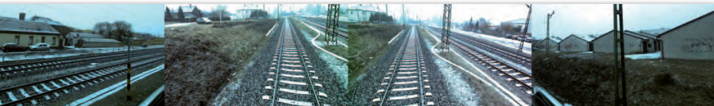
Zdjęcia pozyskane czterema aparatami (po 5 Mpx każdy) modułowego podsystemu aparatów RIEGL VMX-250-CS6
