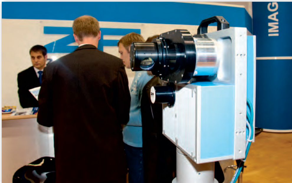
Z+F Profiler 9000 w sekundę pomierzy ponad milion punktów
