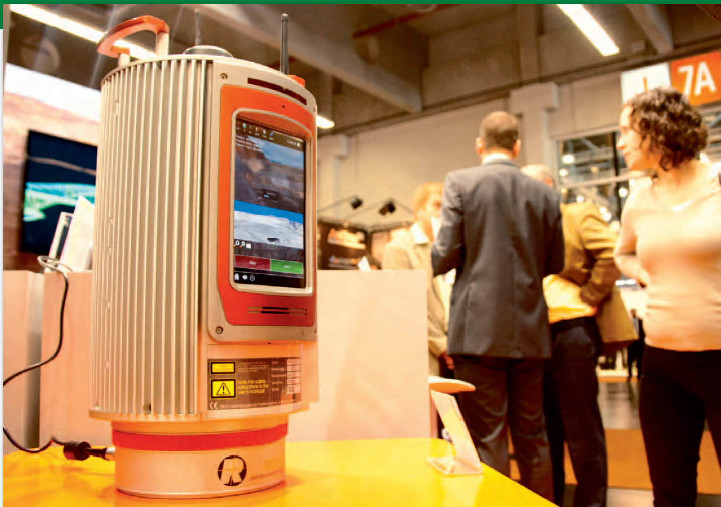
Skaner Riegl VZ-4000 wyróżnia nie tylko zasięg pomiaru, ale również duży, dotykowy ekran
