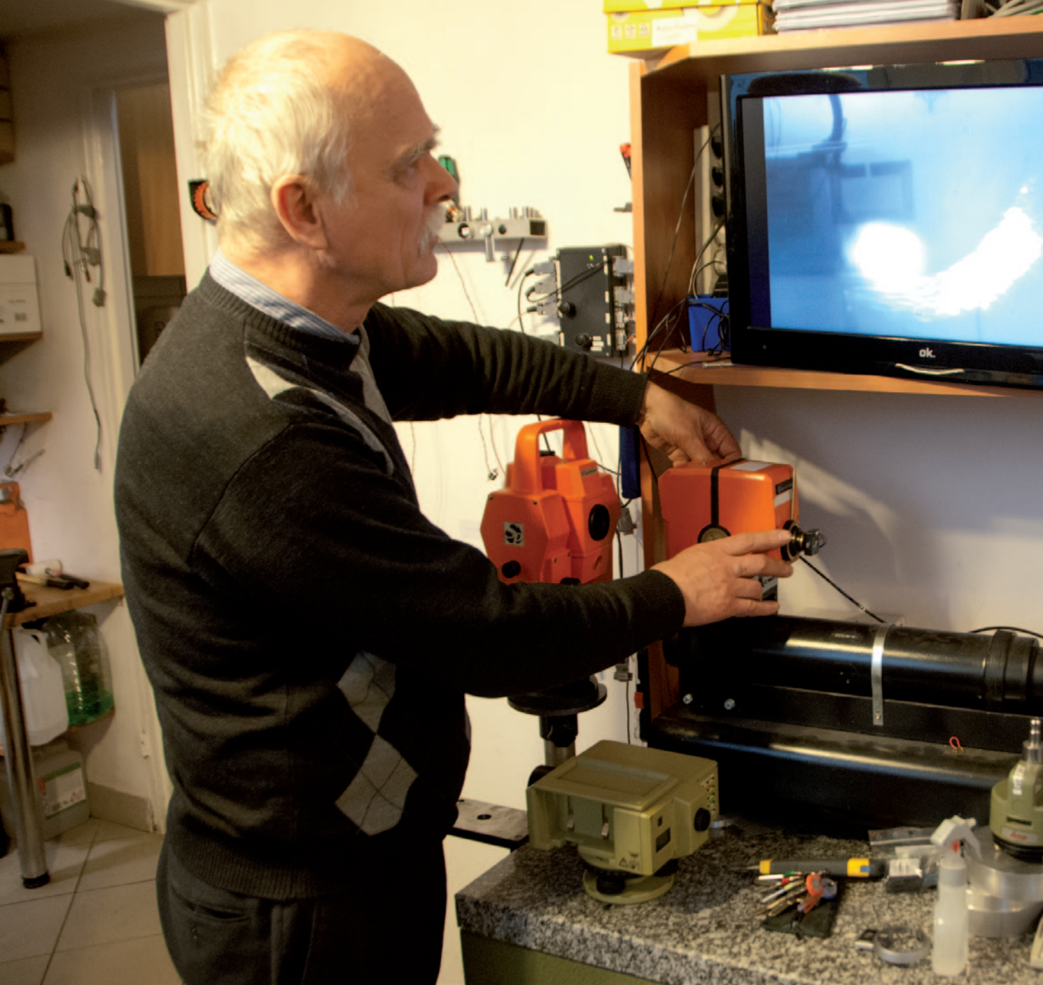
Jerzy Geras prezentuje skonstruowany przez siebie zestaw dwóch kolimatorów, który służy do ustawiania światłowodów w dalmierzu
