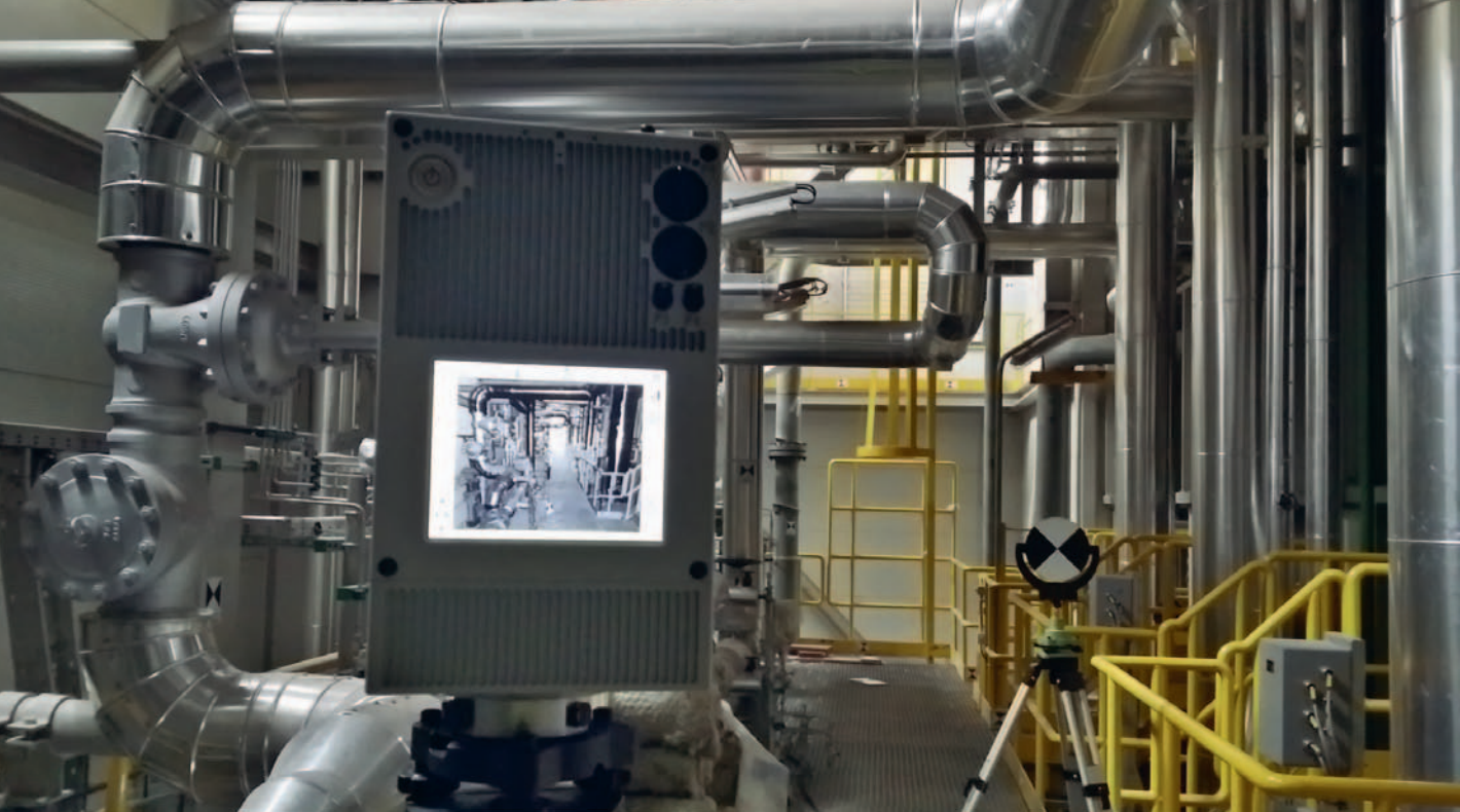
Skanowanie budynku kotłowni w EC Stalowa Wola w celu porównania modelu ze stanem faktycznym
