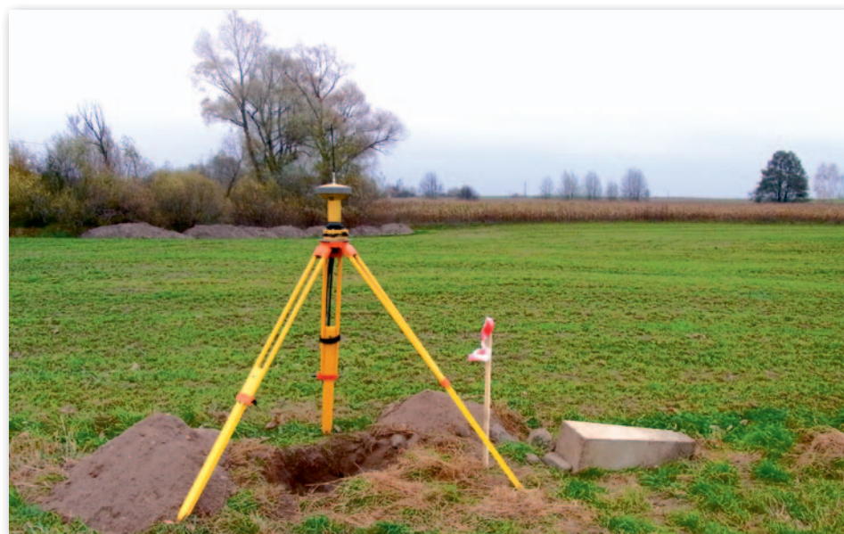
Satelitarny pomiar statyczny punktu osnowy
