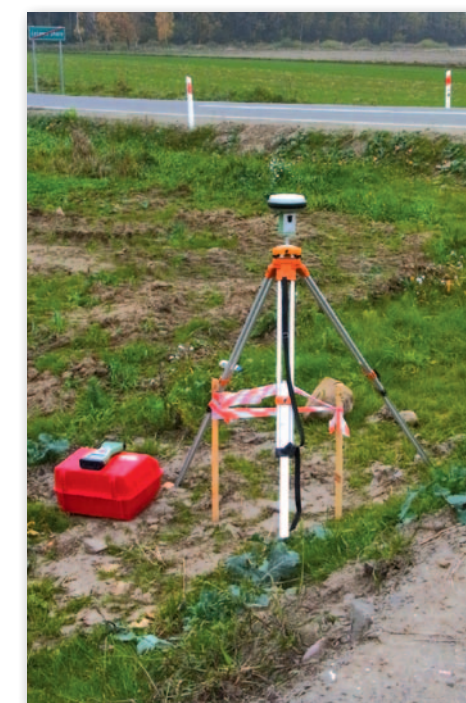
Założenie precyzyjnej osnowy pomiarowej na budowie trasy S8 Jeżewo – Białystok nie byłoby możliwe bez ekspertów z Wojskowej Akademii Technicznej
