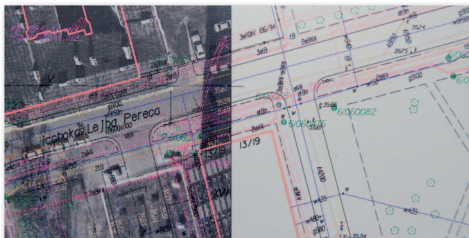
Przeprowadzona przez WPG w latach 90. pionierska w skali kraju próba integracji mapy zasadniczej z ortofotomapą
