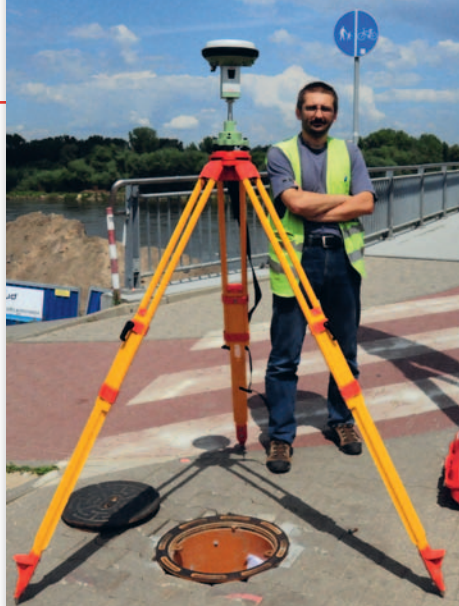
Pod takim niepozornym włazem kryje się punkt osnowy o precyzyjnie wyznaczonych współrzędnych
