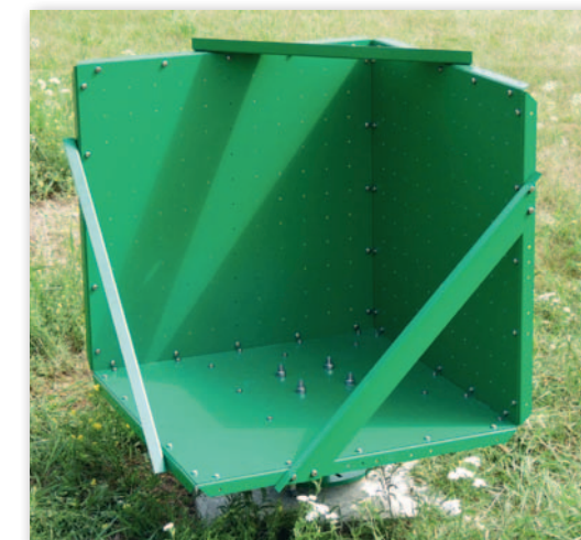
Ten niepozorny metalowy obiekt to reflektor mikrofal, który pozwoli nam precyzyjnie zweryfikować dokładność rozwijanej przez nas technologii
