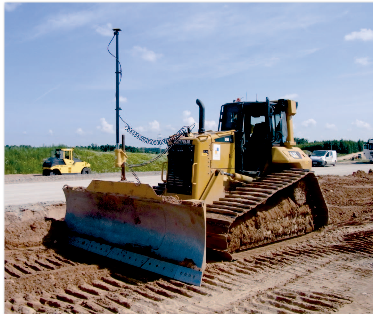
Pracę ciężkiego sprzętu budowlanego kontrolowały systemy sterowania maszynami zasilane naszymi mapami
