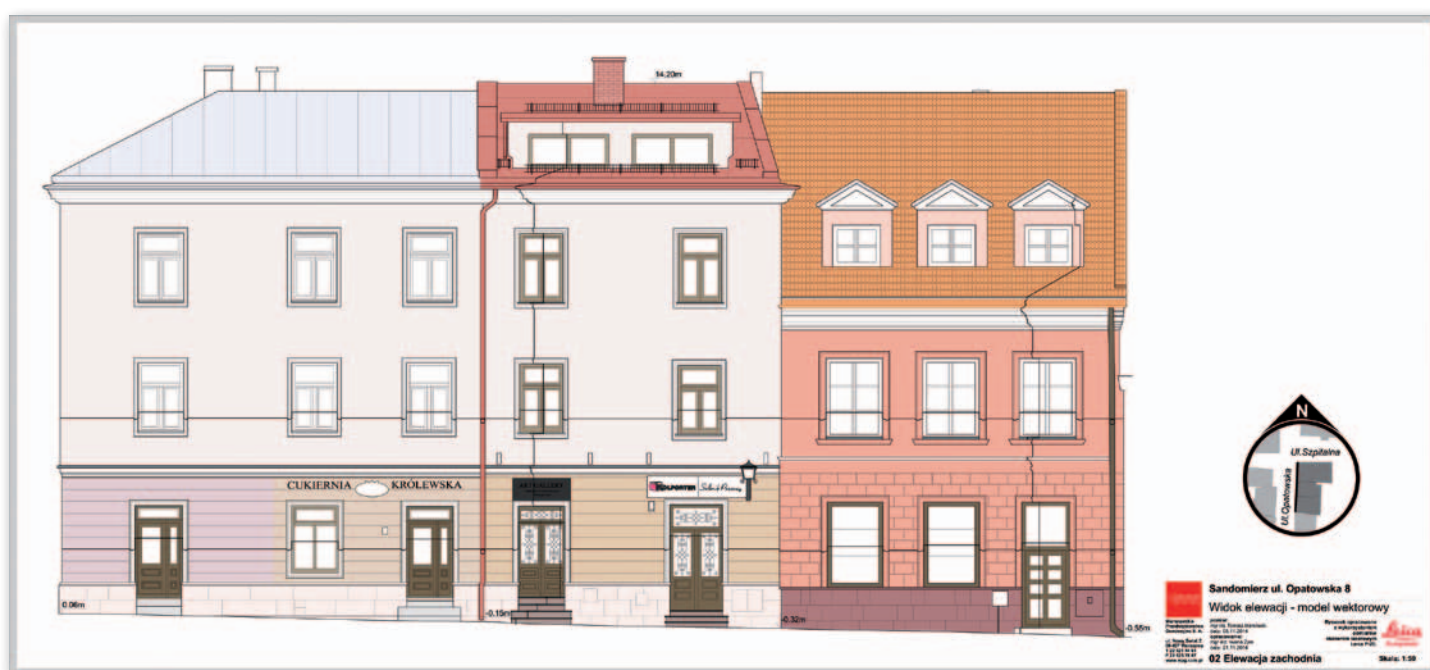
Wektorowy model sandomierskiej kamienicy opracowany w technologii naziemnego skaningu laserowego – jeden z pierwszych efektów współpracy z Politechniką Świętokrzyską
