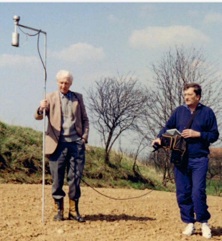
Pomiary charakterystyk spektralnych gleb francuskim spektrometrem CIMEL z udziałem M. Verbrugge z Francji, Pojezierze Mazurskie
