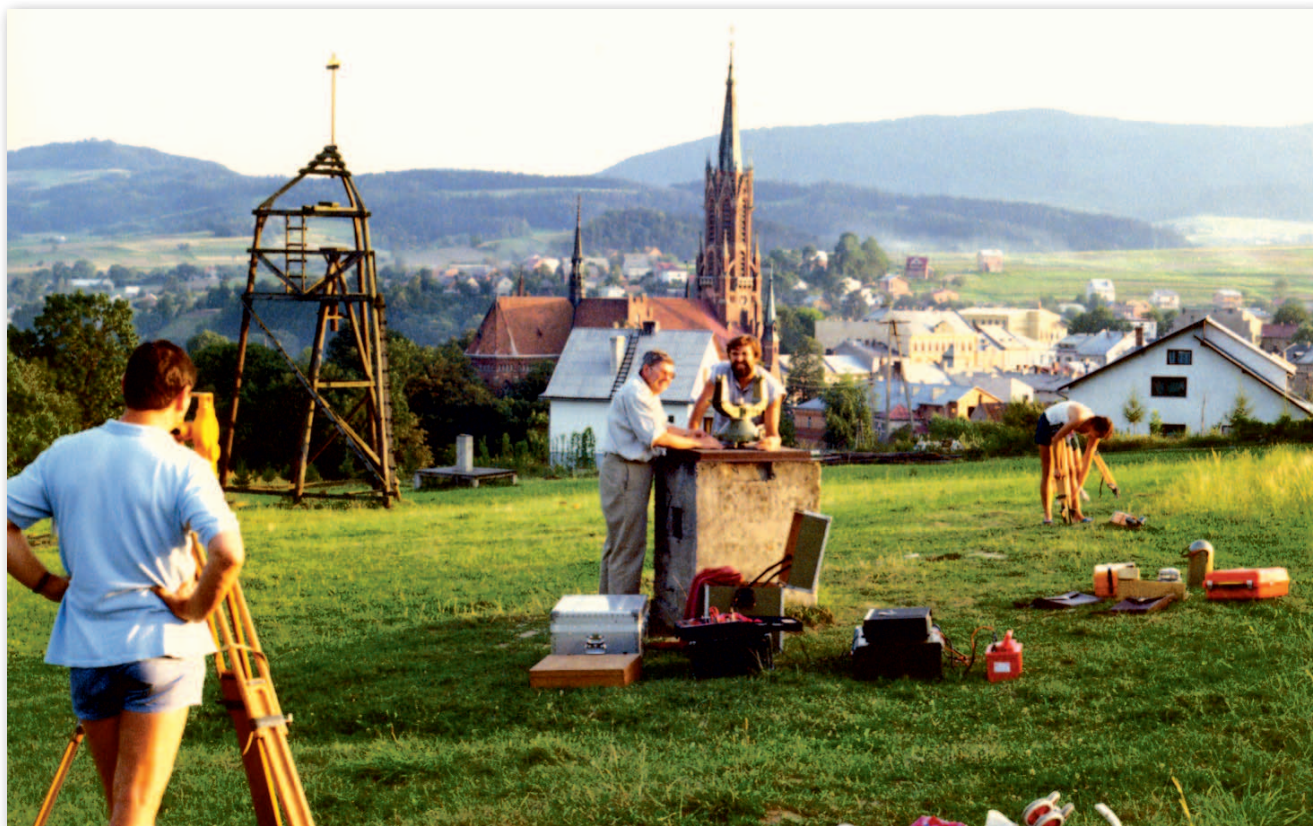
Praktyki studenckie w Grybowie w latach 90. Z lewej wieża triangulacyjna wzniesiona na użytek studentów. Teodolit Wild T3 montują na punkcie osnowy Marcin Barlik i Andrzej Pachuta
