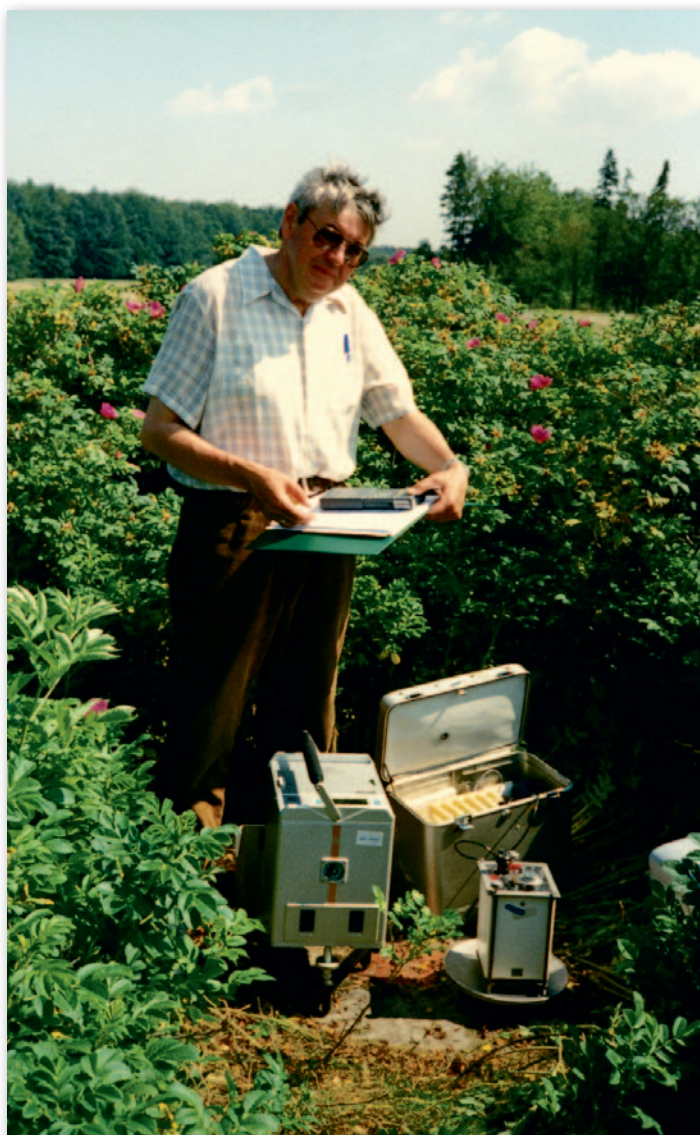
Na poligonie pienińskim prof. Marcin Barlik z grawimetrami: Scintrex CG3 oraz La Coste & Romberg, 1996 r.
