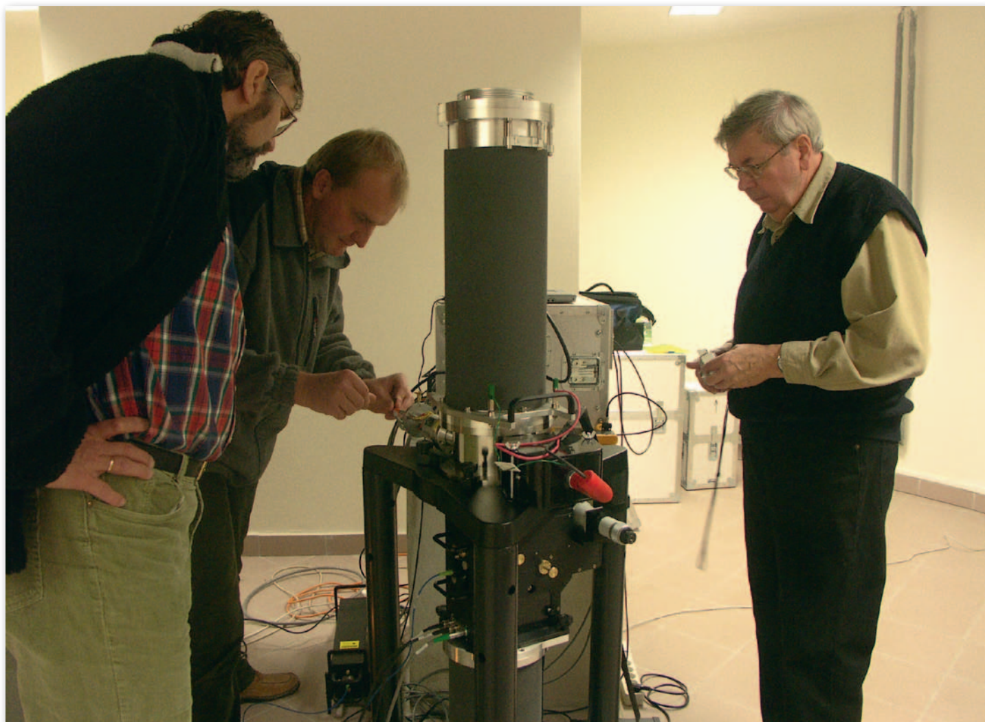
Unikalny grawimetr balistyczny FG5 do pomiarów bezwzględnych przyspieszenia siły ciężkości zainstalowany w obserwatorium PW w Józefosławiu. Od lewej: dr Andrzej Pachuta, dr Tomasz Olszak oraz prof. Marcin Barlik, rok 2005
