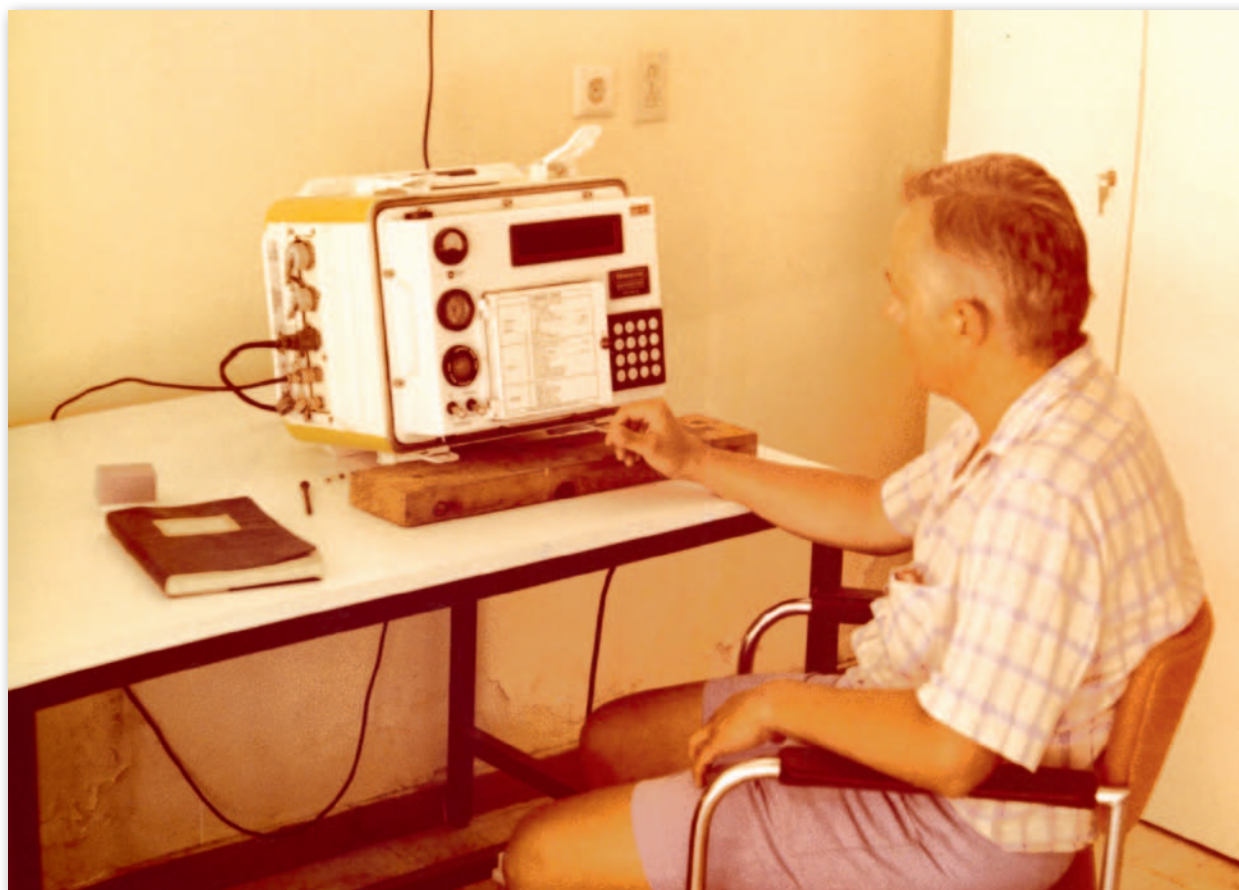
Pomiary odbior- nikiem systemu TRANSIT marki Magnavox, stacja Dionizos, rok 1987
