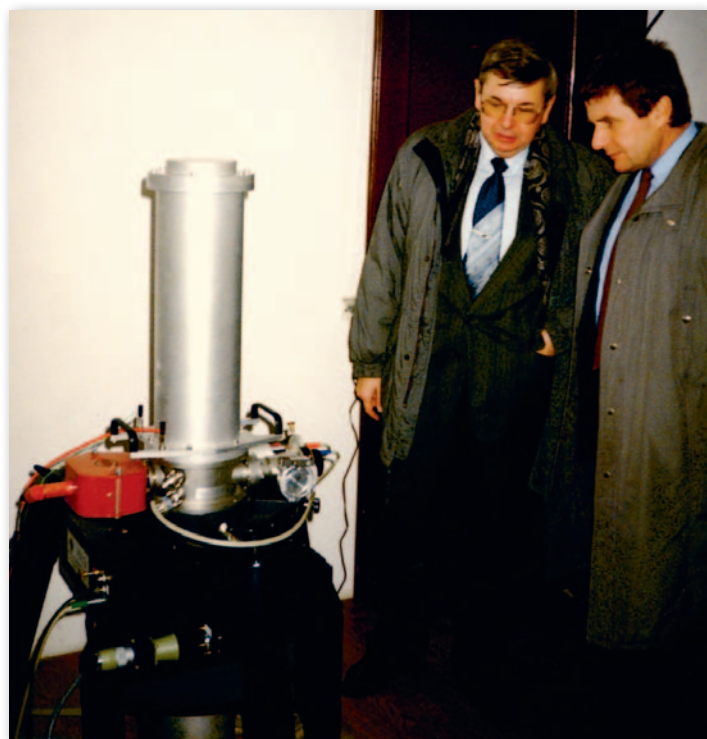
Balistyczny bezwzględny grawimetr FG5 objęty amerykańskim embargiem. W ramach Inicjatywy Środkowoeuropejskiej (CEI) Amerykanie w 1995 r. przywieźli go na pokaz do Lwowa. Marcin Barlik i Mojżesz Marcel ze Słowacji
