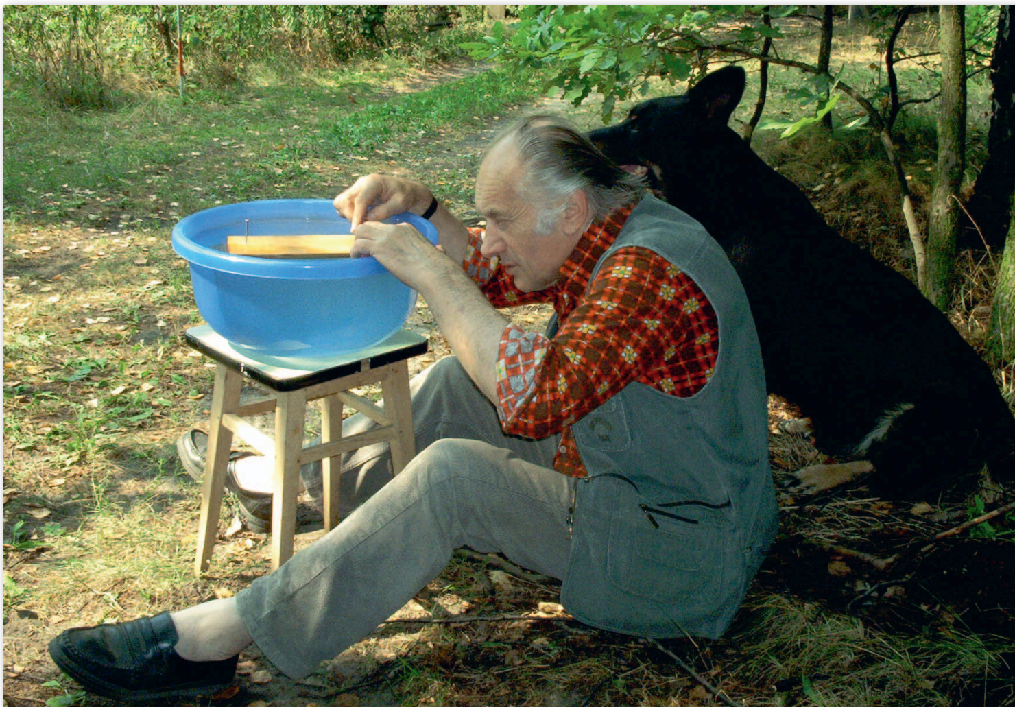
Liczy się wiedza, a nie instrumenty geodezyjne. Niwelacja hydrostatyczna wykorzystana w praktyce do wytyczenia ogrodzenia działki wokół domu na Macierowym Bagnie, rok 2001 r.
